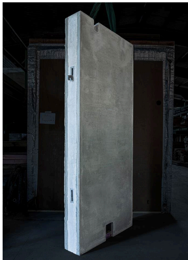
Abb. 72: Demonstrator der Gradientenbetonwand © ILEK
