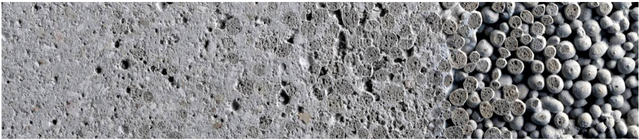
Abb. 60: Geschichteter Porositätsgradient 516 © Institut für Leichtbau Entwerfen und Konstruieren (ILEK), Universität Stuttgart
