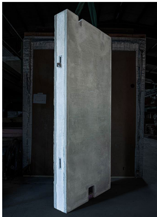
Abb. 72: Demonstrator der Gradientenbetonwand © ILEK
