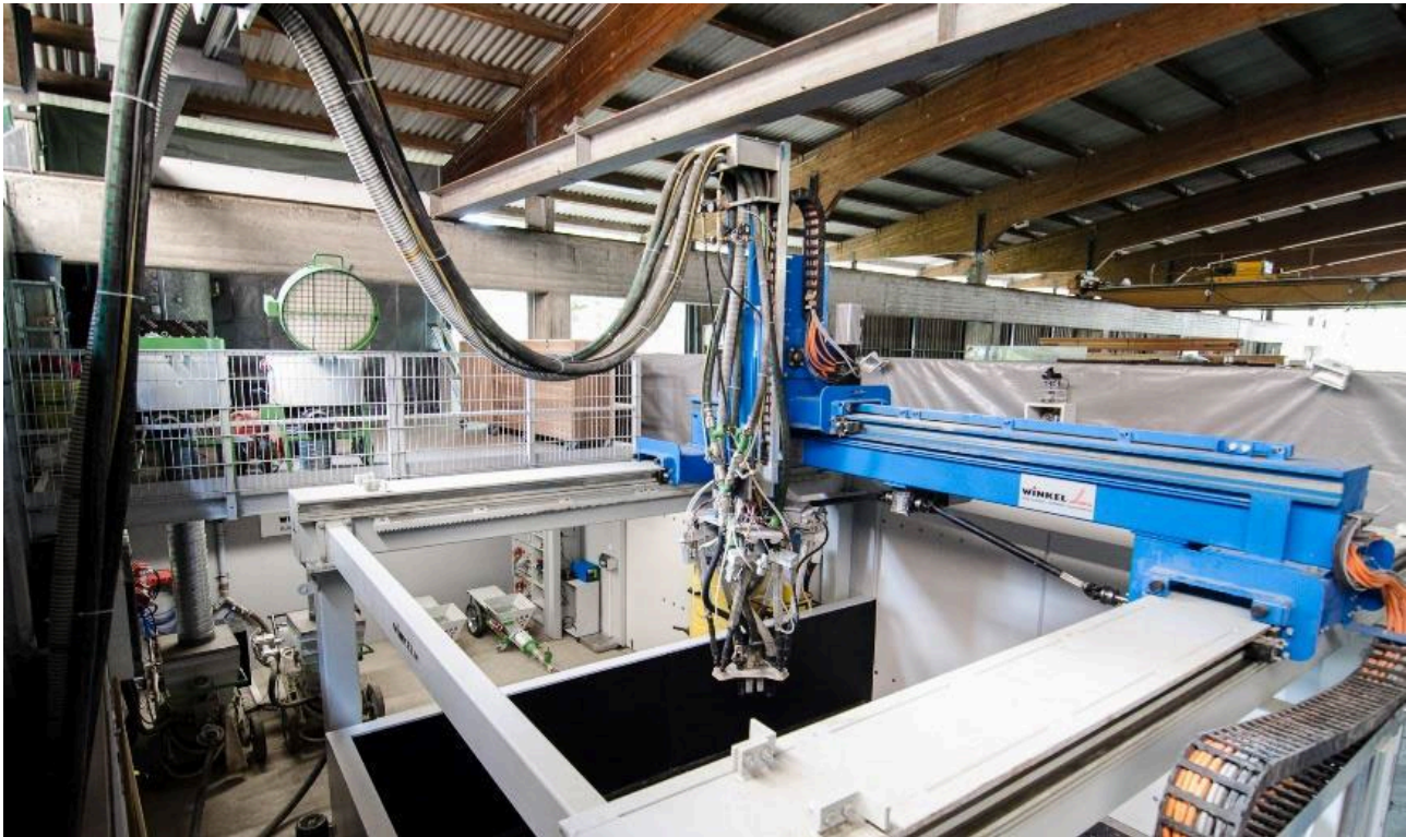
Abb. 64: Applikationssystem mit Stewart-Gough-Plattform © ILEK 528
