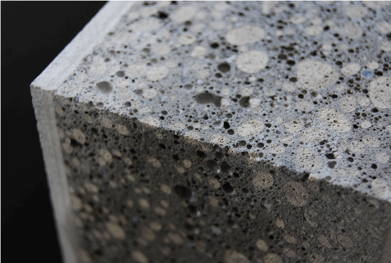
Abb. 75: Hybridbeton-Elemente mit UHPC-Deckschicht und Aerogel-Schaumbeton © G.tecz Eneineering GmbH
