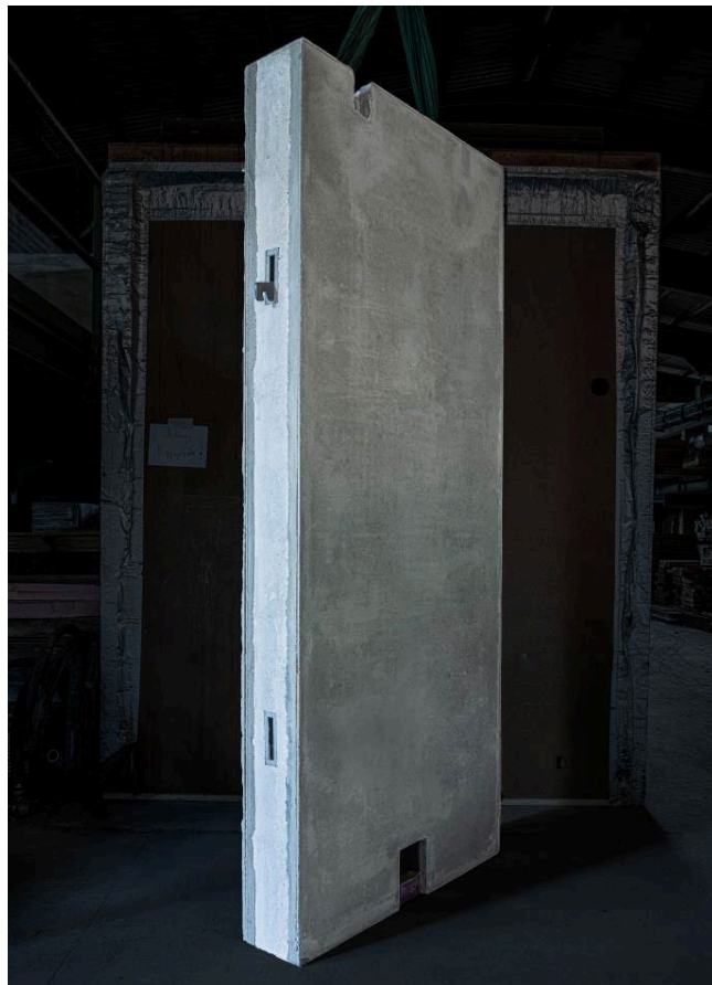
Abb. 72: Demonstrator der Gradientenbetonwand © ILEK
