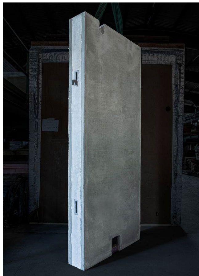
Abb. 72: Demonstrator der Gradientenbetonwand © ILEK
