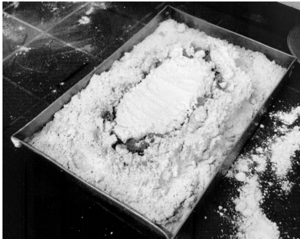
Abb. 5: Der „Großversuch“ mit \approx 2,5 kg Kalk, \approx 1 kg Schwefel, \approx 40 ml Petroleum knapp zwei Minuten nach Beginn der Reaktion. Die dunkelbraune Schwefelschmelze deutet auf eine Oberflächentemperatur von etwa 200 bis 250°C, also noch unter der Entzündungstemperatur von 260°C. Unmittelbar nach dieser Aufnahme, gut zwei Minuten nach Reaktionsbeginn, begann der Schwefel zu brennen (farbige Abbildung im Internet: http://www.edition-sigma.de/TG/H1_07/AbbNibler.PDF ).
