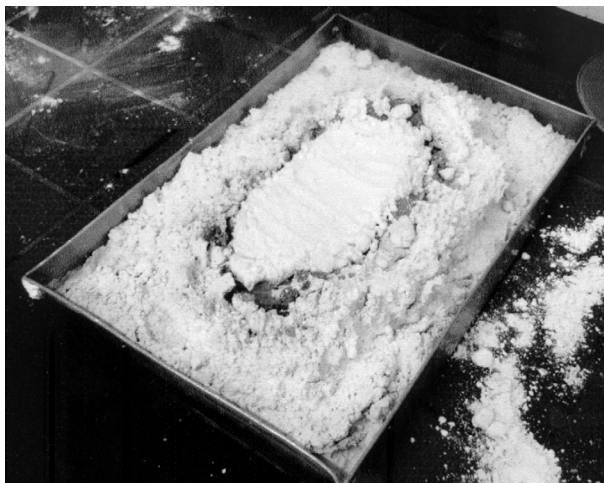
Abb. 5: Der „Großversuch“ mit \approx 2,5 kg Kalk, \approx 1 kg Schwefel, \approx 40 ml Petroleum knapp zwei Minuten nach Beginn der Reaktion. Die dunkelbraune Schwefelschmelze deutet auf eine Oberflächentemperatur von etwa 200 bis 250°C, also noch unter der Entzündungstemperatur von 260°C. Unmittelbar nach dieser Aufnahme, gut zwei Minuten nach Reaktionsbeginn, begann der Schwefel zu brennen (farbige Abbildung im Internet: http://www.edition-sigma.de/TG/H1_07/AbbNibler.PDF ).
