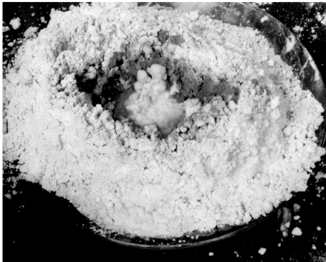
Abb. 4: Schwefel-Petroleum-Mischung im Kalk-Nest, einer der verschiedenen Versuche, mit denen ein wirksames Sekundärfeuer erzeugt werden sollte. Der Schwefel hat sich zum größten Teil gelöst, die dünnflüssige Lösung ist im Kalk versickert (farbige Abbildung im Internet: http://www.edition-sigma.de/TG/H1_07/Abbnibler.PDF ).
