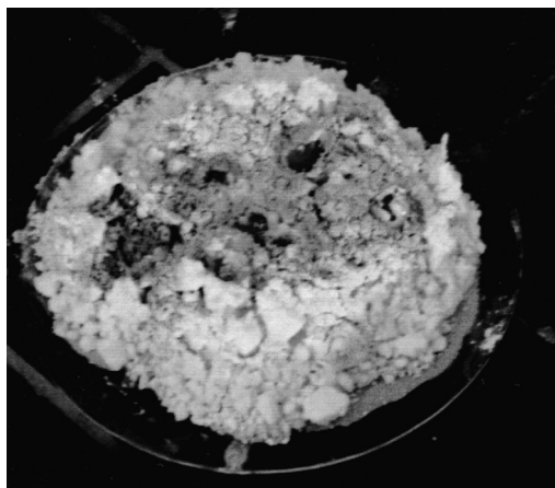
Abb. 2: Schwefel, der auf den Kalk geschüttet war und erst wegen der Volumenvergrößerung des reagierenden Kalkes seitlich abgerutscht ist, hat sich entzündet. Die Temperatur im aktiven Kern ist deutlich über 300^{\circ}\text{C} . Der Durchmesser der Glasschale ist 20 cm, ca. 150 g Kalk und ca. 100 g Schwefel wurden verwendet (farbige Abbildung im Internet: http://www.edition-sigma.de/TG/H1_07/AbbNibler.PDF ).
