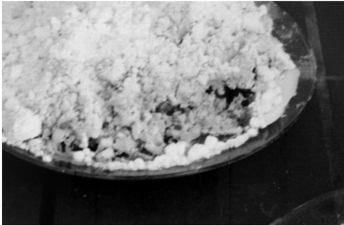
Abb. 1: Der Schwefel hat sich entzündet – aber er brennt nur mit einer kleinen blauen Flamme, Flammhöhe etwa 5 mm, in einer langsam fortschreitenden Front (hier: der dunkelgraue Fleck am rechten unteren Rand – die farbige Abbildung ist im Internet abrufbar unter: http://www.edition-sigma.de/TG/H1_07/AbbNibler.PDF ). Die hier abgebildete Situation, etwa fünf Minuten nach der Reaktion, kann sich so bis zu einer Stunde hinziehen!
