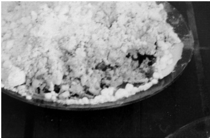
Abb. 1: Der Schwefel hat sich entzündet – aber er brennt nur mit einer kleinen blauen Flamme, Flammhöhe etwa 5 mm, in einer langsam fortschreitenden Front (hier: der dunkelgraue Fleck am rechten unteren Rand – die farbige Abbildung ist im Internet abrufbar unter: http://www.edition-sigma.de/TG/H1_07/AbbNibler.PDF ). Die hier abgebildete Situation, etwa fünf Minuten nach der Reaktion, kann sich so bis zu einer Stunde hinziehen!
