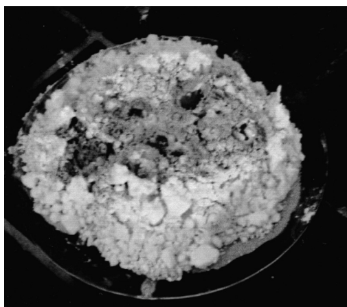
Abb. 2: Schwefel, der auf den Kalk geschüttet war und erst wegen der Volumenvergrößerung des reagierenden Kalkes seitlich abgerutscht ist, hat sich entzündet. Die Temperatur im aktiven Kern ist deutlich über 300^{\circ}\text{C} . Der Durchmesser der Glasschale ist 20 cm, ca. 150 g Kalk und ca. 100 g Schwefel wurden verwendet (farbige Abbildung im Internet: http://www.edition-sigma.de/TG/H1_07/AbbNibler.PDF ).
