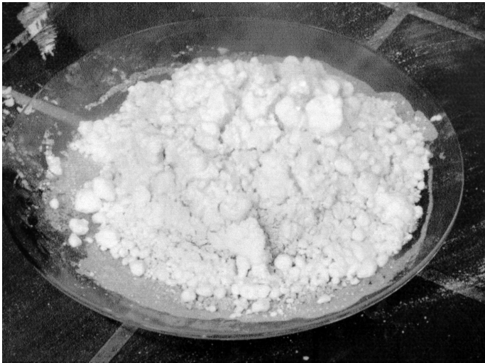
Abb. 3: Eine Mischung aus Kalk, Schwefel und Petroleum reagiert auf die Wasserzugabe weniger heftig und langsamer als eine reine Kalk-Schwefel-Mischung. Dementsprechend kommt es nicht zur Entzündung des Schwefels und erst recht nicht zur Entzündung des Petroleums (farbige Abbildung im Internet: http://www.edition-sigma.de/TG/H1_07/AbbNibler.PDF ).
