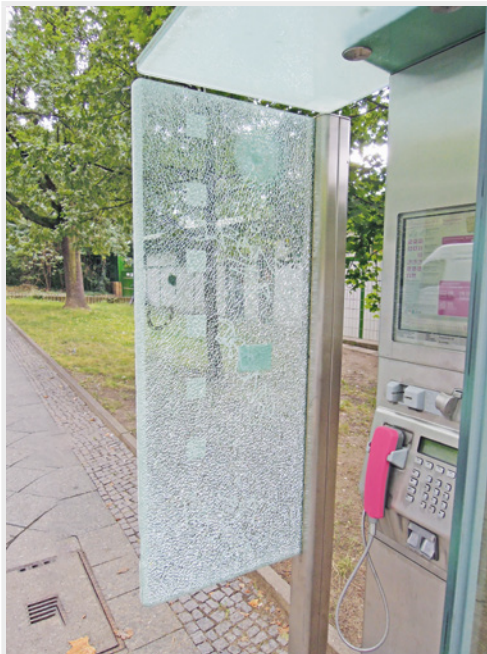
Abb. 80: Das Vertrauen der früheren TRLV in VSG aus ESG wird von DIN 18008 nicht geteilt
