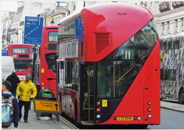
Abb. 86: Verglasung absturzsichernd, gebogen und geklebt
