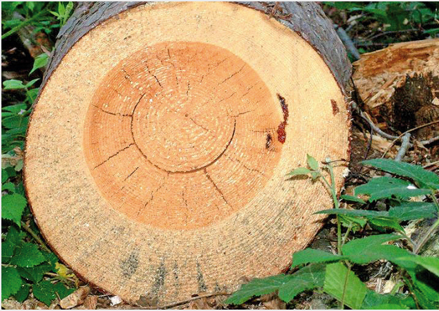
Abb. 20: Kernholz und Splintholz
