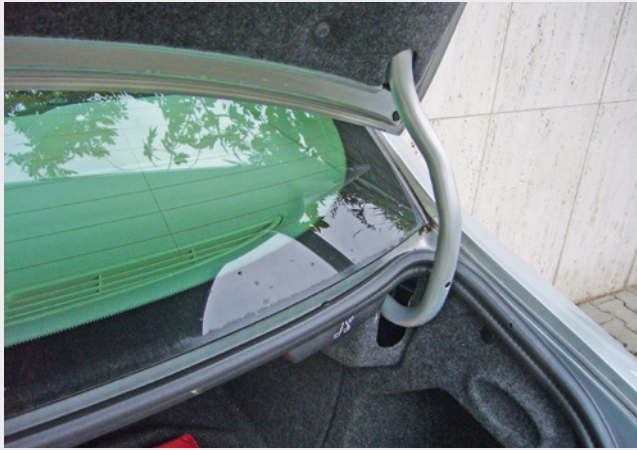
Abb. 64: Geklebte Verglasung am Auto mit geschliffener Glaskante und Falzentwässerung in eine Rinne
