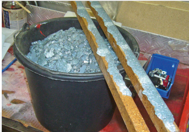
Abb. 10: Reste einer geborstenen ESG-Scheibe
