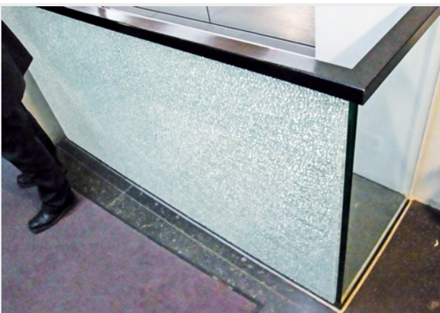
Abb. 94: VSG aus ESG mit unge- schützter Kante nach dem Stoß
