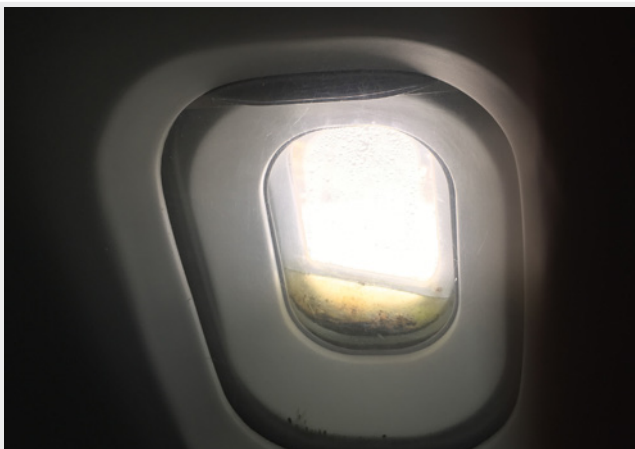
Abb. 46: Wasser im Scheibenzwischenraum sogar im Flugzeug
