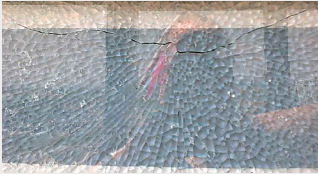
Abb. 9: »Schmetterling« im ESG [Quelle: Raach]
