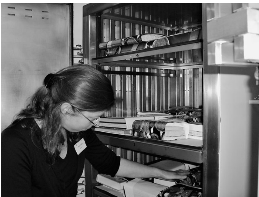
Abb. 2: Während der Gefriertrocknung: Blick in den Trockenschrank (Birgit Geller)
