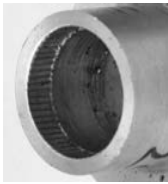
Bild 3: Dünnwandige Aluminiumnabe einer spanend erzeugten Verbindung mit Q = 0,76 und 25 mm Außendurchmesser
