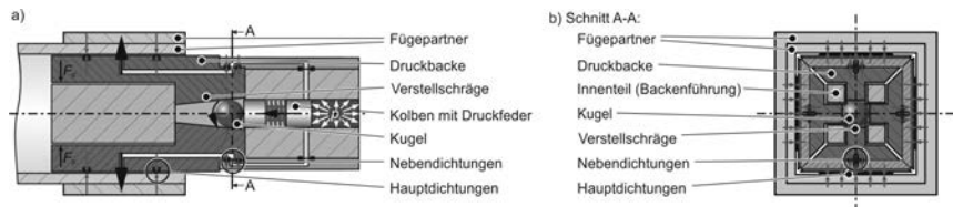
Bild 4: Prinzipskizze der Fügezone (nicht maßstabsgetreu)
