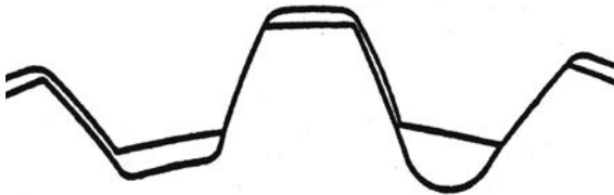
Bild 2: Zahnfußvarianten nach ISO 4156 [2], links „flat root“ und rechts „fillet root“
