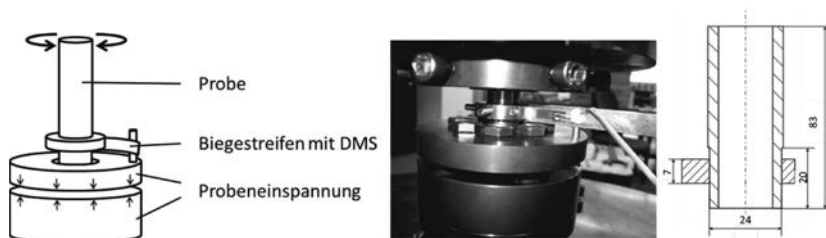
Bild 6: Prinzipskizze und Bild der Vorrichtung zur Verdrehwinkelbestimmung und die verwendete Probengeometrie
