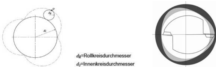
Bild 4: Allgemeine Trochoide mit 3 „Ecken“ [7] Bild 5: Innenpolygon P3G im RUD- Verfahren [6]
