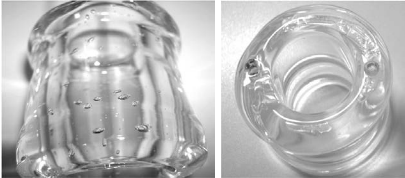
Bild 3: Glashülse gefüllt mit Ultraschallgel links vor, rechts nach Zentrifugation [3]
