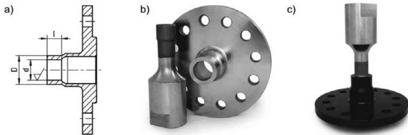
Bild 1: a) Nabe im Vollschnitt; b) beschichtete, ungefügte Probe; c) thermisch gefügte Probe
