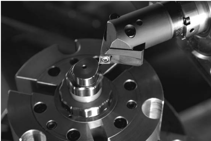
Bild 12: Geringere Stückzeiten für niedrigere Stückkosten. Das Oszillations-Unrunddrehen verkürzt erheblich die Prozessketten, reduziert die Auftragsdurchlaufzeiten durch die spe-zielle Kinematik. Zugleich wird durch Komplettbearbeitung und Reduzierung der Aufspan-nungen die Fertigungsqualität gesteigert.
