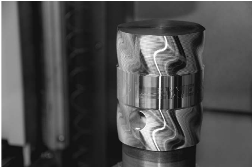
Bild 11: Hohe Genauigkeit und Oberflächenbeschaffenheit mit dem WEISSER HOT- System.
