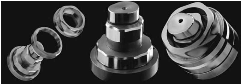
Bild 13: Die Vorteile polygonaler Verbindungen konzentrieren sich auf folgende Fakten: Selbstzentrierung durch homogene Krafteinleitung, geringe Kerbwirkung, ca. 25% höhere Wechselfestigkeit, idealer Einsatz für hohe Drehmomente.
