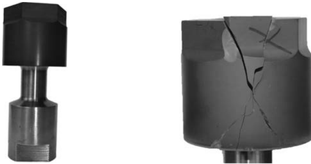
Bild 1: Probengeometrie des hybriden Querpressverbands (links) und beim Fügen gebrochene Nabe (rechts)
