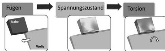
Bild 4: Schritte der durchgängigen Simulation des Rändelpressverbandes
