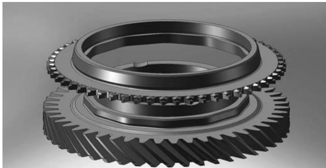
Bild 7: Schaltrad und Kupplungskörper mit 12-fach PWNV [12]
