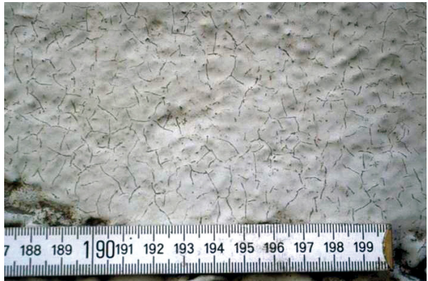
Bild 59 ■ Rissnetz in einer gealterten, spröde gewordenen Beschichtung als Folge zweidimensional in der Oberfläche wirkender Verkürzungsbestrebungen
