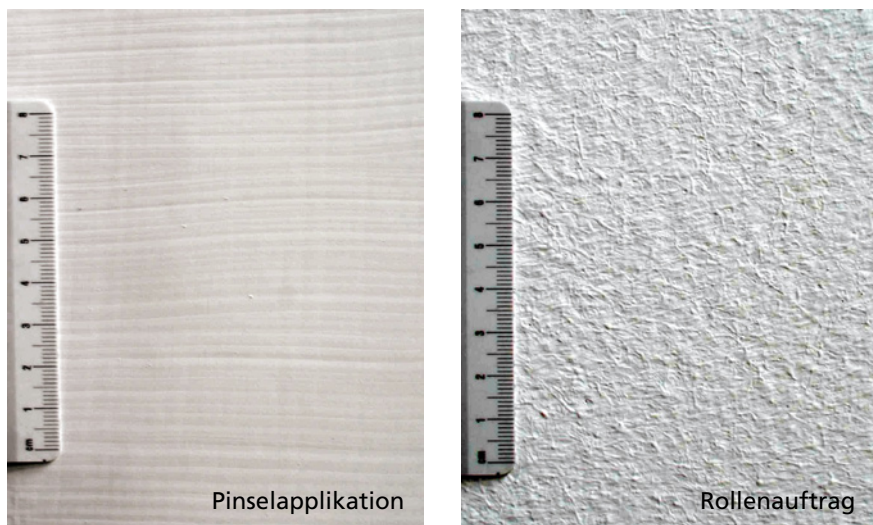
Bild 14 ■ Beschichtungsflächen, abhängig vom Beschichtungswerkzeug; links: Pinselstriche, rechts: Orangenschalenstruktur
