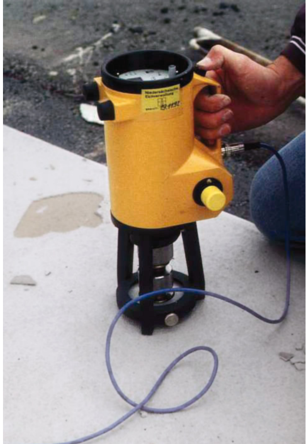
Bild 139 ■ Versuchs- vorrichtung zur Durch- führung des Abreiß- versuchs (Haftzug- festigkeit) an starren Bodenbeschichtungen, s_{\text{mit}} > 500 \mu\text{m}
