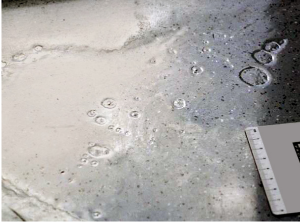
Bild 47 ■ Erscheinung G – Benetzungsstörungen beim Beschichten eines Fußbodens, die zur krater- artigen Ausbildung von Fehlstellen führten
