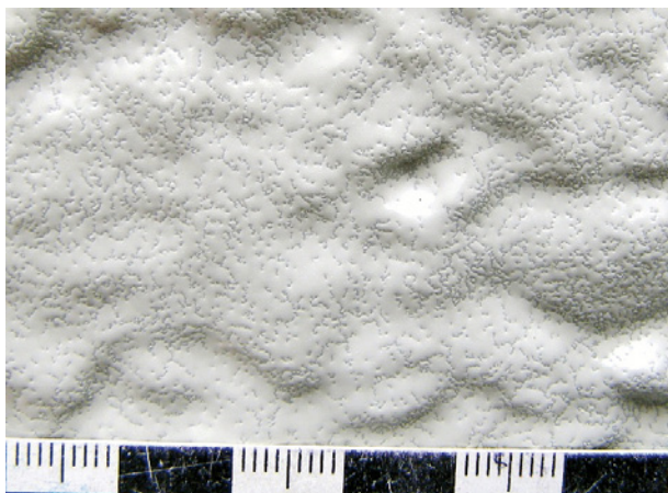
Bild 42 ■ Erscheinung C – zu geringer Materialauftrag beim Airlesspritzen und zu geringes Verlaufsvermögen wegen zu niedriger Temperatur verursacht schorartige Beschichtungsstruktur
