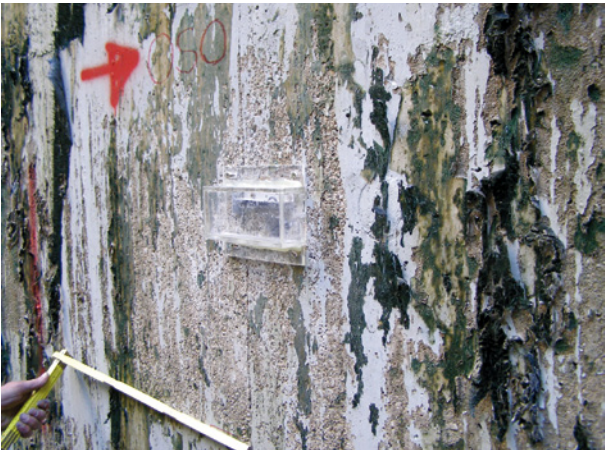
Bild 75 ■ Sensor zur Erfassung von Rissbreitenänderungen an der Schaleninnenseite eines Naturzugkühlturms
