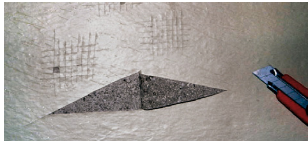
Bild 142 ■ Rissüberbrückende Betonbeschichtung, s_{\min} \geq 300 \mu\text{m} ; Spitzwinkelschneideversuch zeigt schlechten (tatsächlichen), Gitterschnittversuch zeigt guten (vermeintlichen) Haftverbund an
