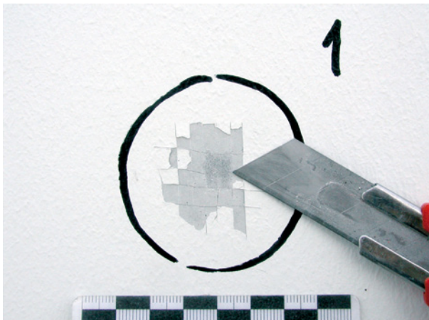
Bild 148 ■ Schlechtestmöglicher Gitterschnittkennwert Gt 5; pulvrige Schicht auf Beton lässt sich leicht abschaben
