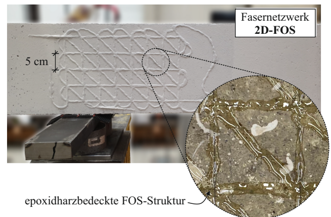
Bild 2. 2D-FOS appliziert an einem Stahlbetonbalken im Bereich des Auflagers. Grafik: RWTH Aachen
