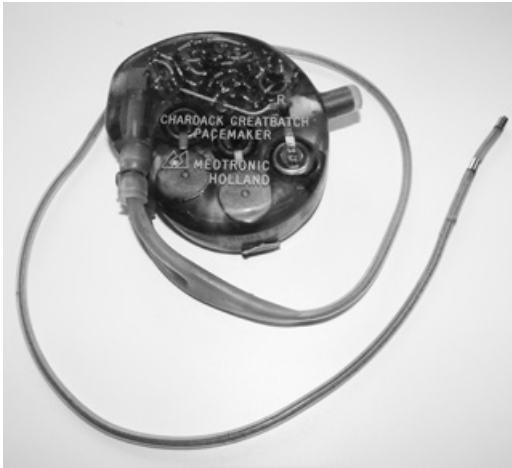
Abb. 1 Herzschrittmacher von Medtronic, erstes massenproduziertes Implantat mit Batterien, seit den 1960ern eingesetzt (Foto: Klinikum Chemnitz gGmbH/Andreas F. Walther)
