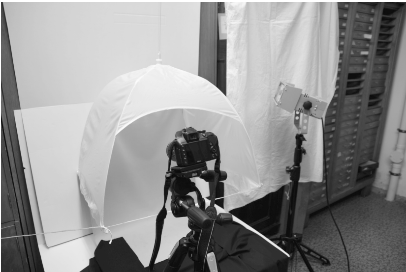
Abbildung 3: Lichtzeltkonstruktion für Fotoaufnahmen. Foto: Jörg Neumann.
