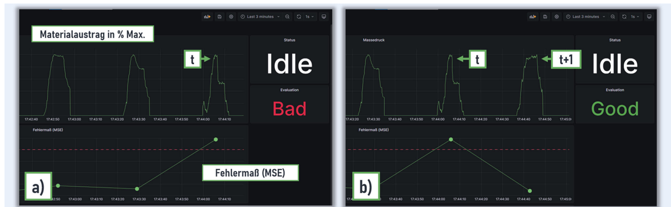
Bild 6. Visualisierung der Anwendung im Grafana-Dashboard. Zeitlicher Verlauf des Materialauszugs und KI-Bewertung des Drucks im zeitlichen Verlauf: zum Zeitpunkt t a) und Zeitpunkt t+1 b). Grafik: wbk
