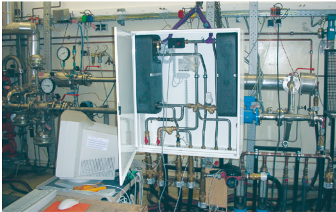
■ Abb. 82: Übergabestation der solaren Nahwärme Hirtenwiesen II in Crailsheim im Testlabor des Reglerherstellers
