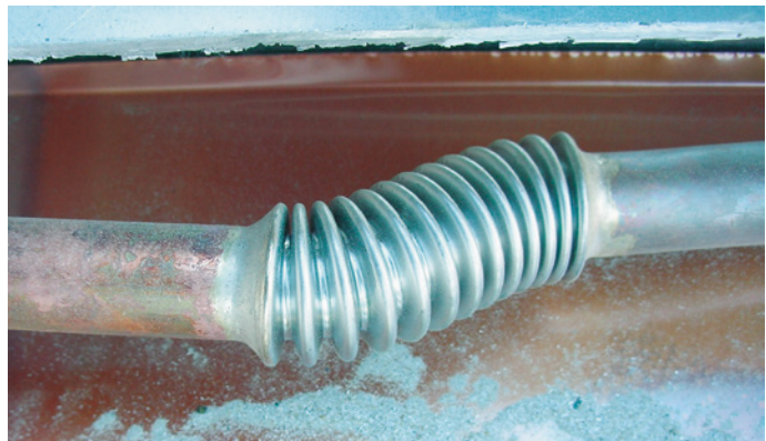
■ Abb. 89: Zerstörter Längenausdehnungskompensator
