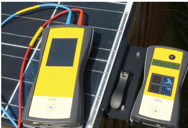
Bild 153: Kennlinienmessgerät (links) mit Einstrahlungs- und Temperatursensor (rechts)
