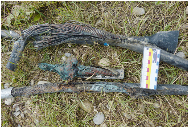
Bild 4: Schadensreste weiterer beschädigter Generator-Hauptleitungen
