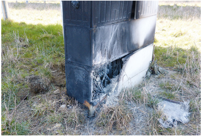
Bild 1: Brand in einem Generatoranschlusskasten
