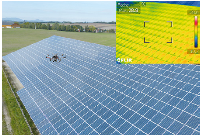
Bild 152: Schnellere Übersicht und optimale Positionierung mit Flugdrohne
