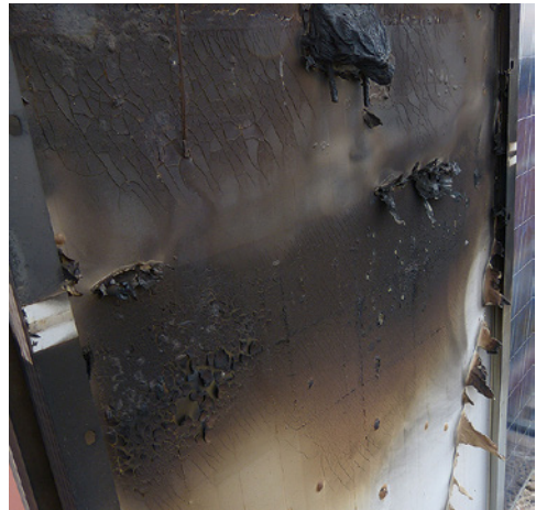
Bild 133: Durch Brand zerstörte Module (oben und rechts)
