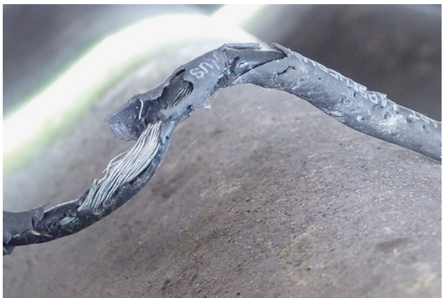
Bild 88: Freiliegende Leiterlitzen können zu gefährlichen Situationen führen.
