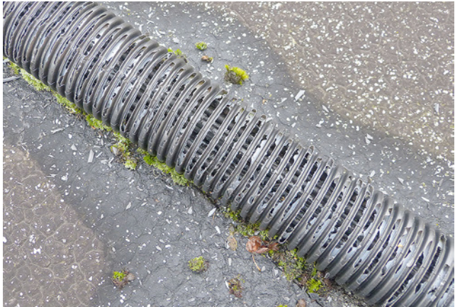
Bild 27: UV-Schädigung am Schutzrohr: Die Anlage ist ca. 5 Jahre alt.
