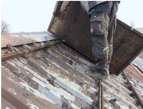
Bild 133: Durch Brand zerstörte Module (oben und rechts)
