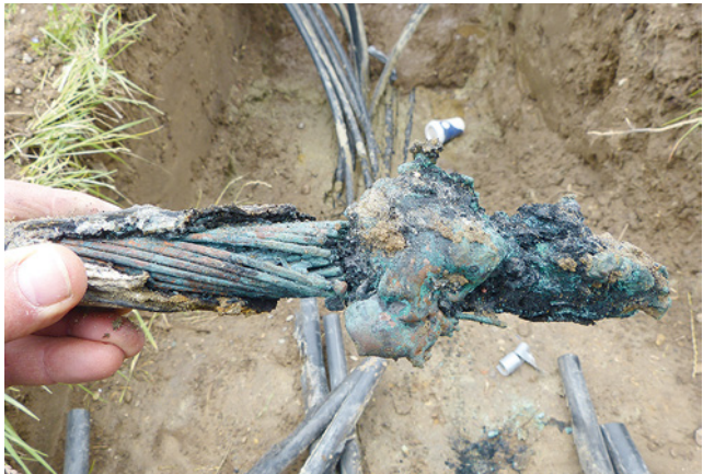
Bild 3: Verschmorte Erdleitung einer Generator-Hauptleitung mit Kupferschmelze
