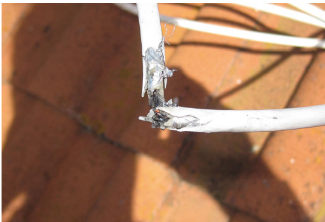
Bild 126: ..., nur bei näherer Betrachtung ist das beschädigte Koaxialkabel erkennbar.
