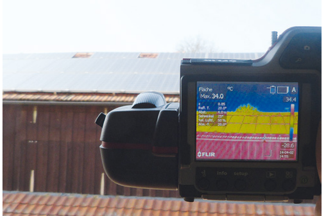
Bild 146: Wärmebildaufnahme bei Photovoltaikanlagen
