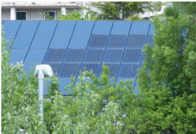
Bild 61: Farblich unterschiedliche Module mit fleckiger Struktur
