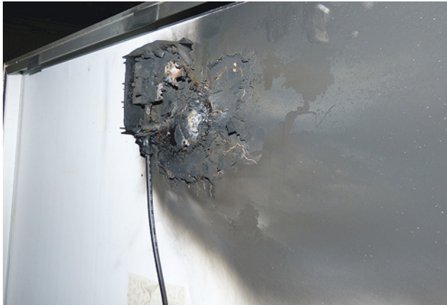
Bild 135: Verschmorte Anschlussdose an einem Modul: Die Ursache ist ein Herstellungsfehler.
