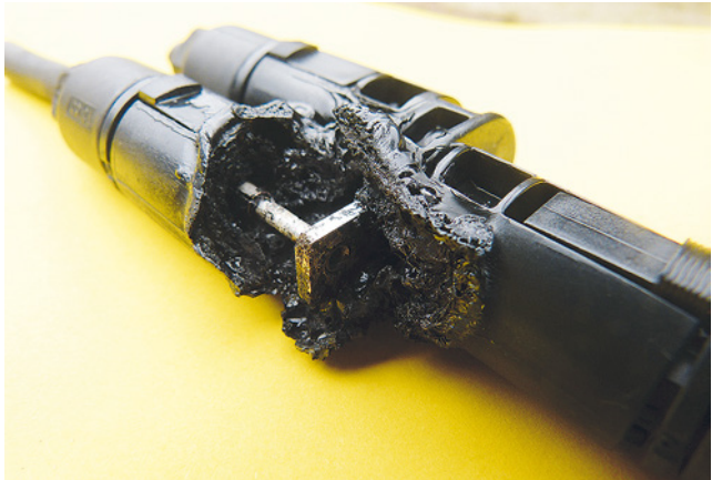
Bild 132: Brandtechnische Untersuchung einer durch Lichtbogenzündung zerstörten Steckverbindung
