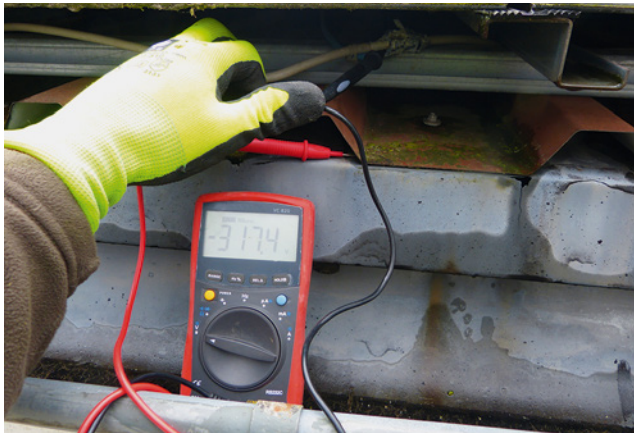
Bild 45: Die messbare Spannung zwischen mangelhaft isolierter Leitung und Metaldach: 317 Volt!
