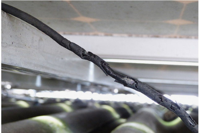
Bild 87: Kabel, das durch einen Marder zerstört wurde
