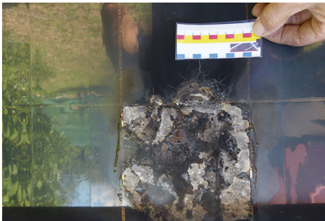
Bild 56: Folgen eines »Hotspots«, der an einen Schaden nach Blitzeinschlag denken lässt
