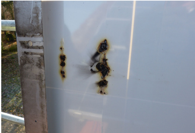
Bild 55: Thermische Auswirkungen sogenannter Hotspots auf der Modulrückseite
