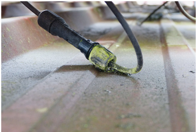
Bild 23: Dauerbenässung eines Steckers und deren Folgen: Moosbesatz, Feuchtigkeitseindrang und Isolationsprobleme
