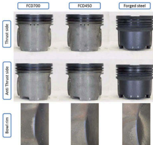
Bild 12: FCD700, FCD450 und Stahlkolben nach Überlast-Splittest eines Motors bei 25MPa.
