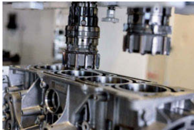
Bild 5: Tansferhonmaschine zum Formhonen light und Arbeitsstation mit Konischhonen
