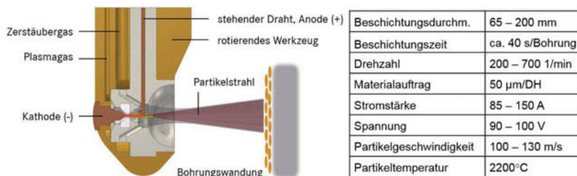
Bild 5: Prinzip und Kennwerte des RSW-Beschichtens
