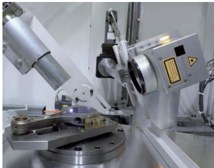
Bild 4: Laserstrukturieren von Titan-Pleuel in der Serienfertigung mit Scanner Optik, Drehvorrichtung und Absaugrohr
