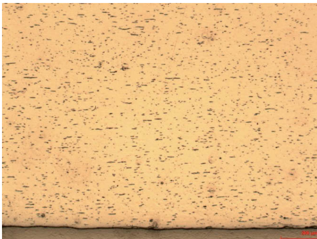
Bild 5: Struktur der Legierung AlBi5Cu2Mn im Lager nach der Produktion x – 50
