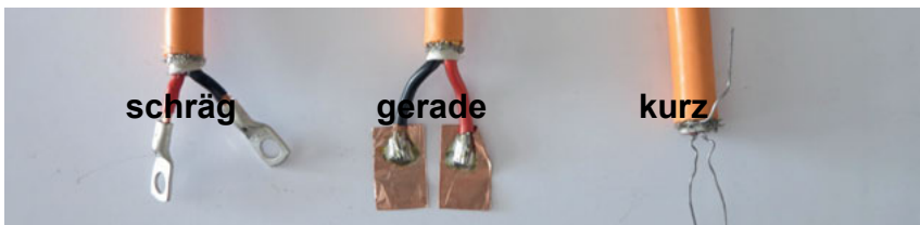
Bild 5.6: Unterschiedliche Kabelkontaktierungen zur Vermessung der Kabelimpedanz
