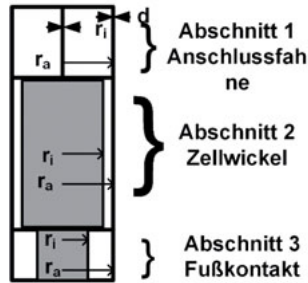
Bild 4.4: Berechnung der Batteriezelle als Koaxialkabel
