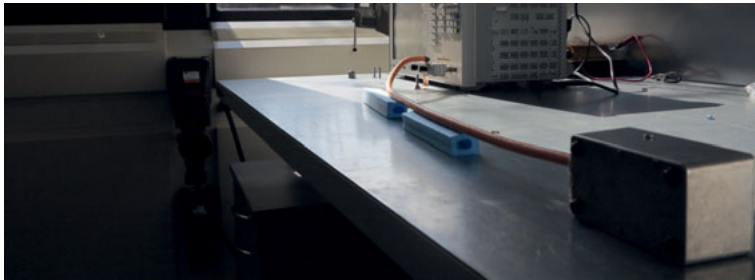
Bild 6.7: Messaufbau der Kabel-Komponenten-Kombination über einer Massefläche
