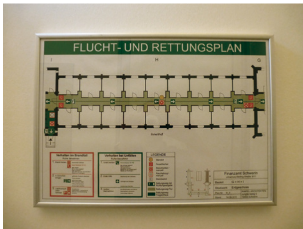
Bild 34 ■ Flucht- und Rettungsplan nach DIN 4844-3
