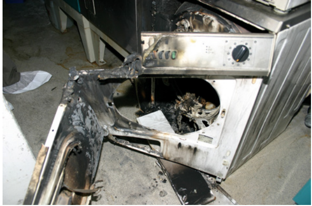
Bild 89 ■ Brandschaden am unteren Teil des Wäschetrockners
