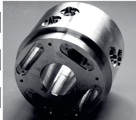
Bild 80 Telemetrikörper zum Einbau verschiedener Elektronikmodule bzw. zur mantelseitigen Montage von Drucksensoren, Foto mit gesteigertem Kontrast
