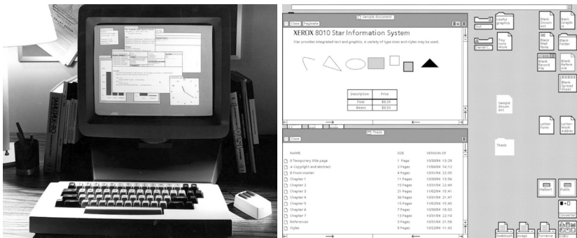
Abb. 10: Die Smalltalk-Benutzeroberfläche auf einer späteren Version des Xerox Alto (links) und das WIMP-User Interface des Xerox Star (rechts)
