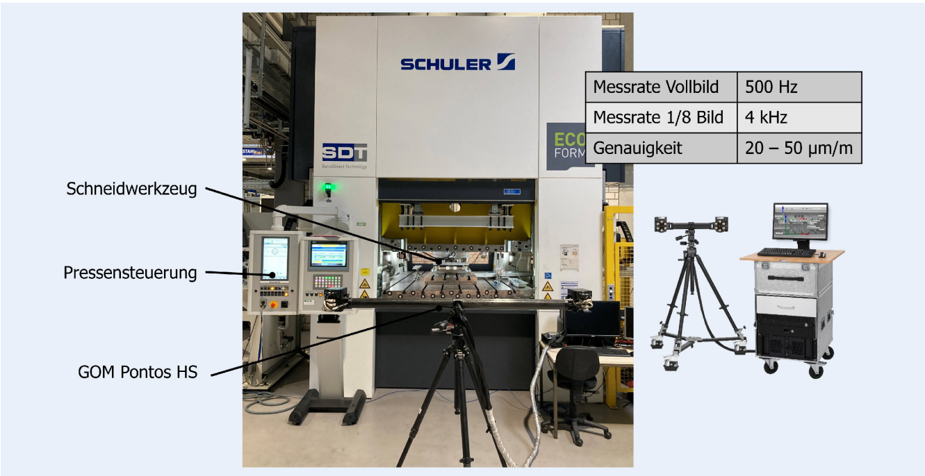
Bild 9. Verlagerungsmessung mittels Verlagerungsmesssystem GOM Pontos. Foto: IFUM
