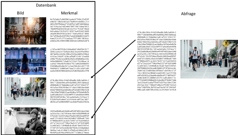
Abbildung 4.3: In der Datenbank werden Bilder und Merkmale gespeichert. Die Abfrage erzeugt aus dem Abfragebild eine Menge von Merkmalen. Diese werden in der Datenbank gesucht. Eine Übereinstimmung zeigt, dass Teile eines Bildes in der Datenbank in dem Bild der Abfrage vorkommen.
