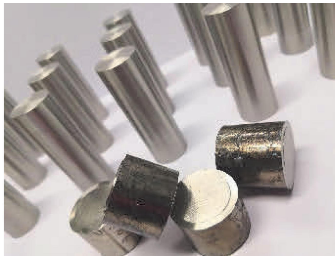
Bild 4. Ausgangsmaterial für die Kaltumformung. Links: gegossenes Stangenmaterial, rechts: Proben nach der spanenden Bearbeitung. Foto: Fraunhofer IWU
