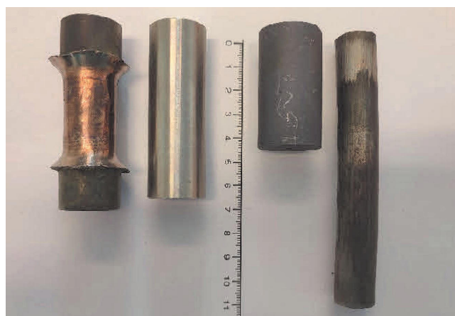
Bild 8. Vergleich der Umformergebnisse. Links: gewalztes Bauteil (L = 73 mm, Ø = 23 mm) und Querkeilwalzen Anfangsform (L = 68 mm, Ø = 23 mm), rechts: Anfangsform des Voll-Vorwärts-Fließpressens (L = 44 mm, Ø = 26 mm) und fließgepresstes Bauteil (L = 110 mm, Ø = 16,5 mm). Foto: Fraunhofer IWU
