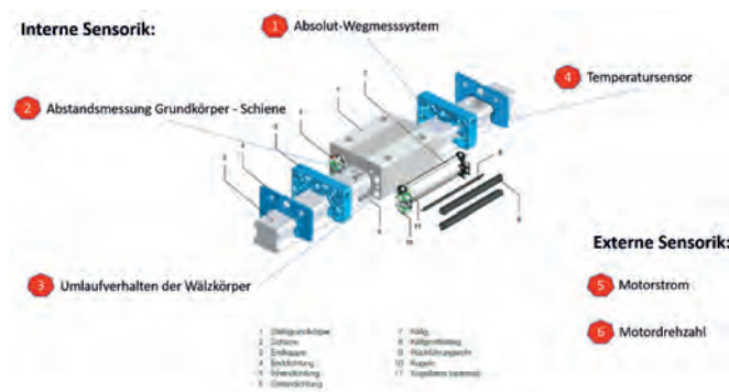
Bild 1: Sensoranordnung für Profilschienenführung (Bildquelle: NTN-SNR)
