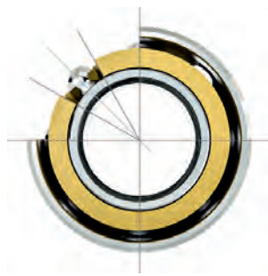
Bild 2b: Kalotte mit trichterförmiger Kontur im Sonderdesign
