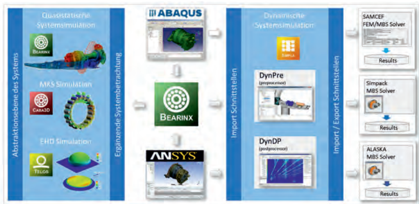
Bild 2: Simulationsplattform BEARINX, SIMPLA und Schnittstellen der Firma Schaeffler
