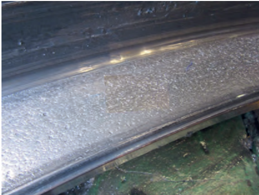
Bild 2: Verschleißzustand in einem Großwälzlager aus einem Mining-Bagger
