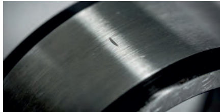
Bild 2: Aufnahme eines Schadens auf der Laufbahn eines Zylinderrollenlagers
