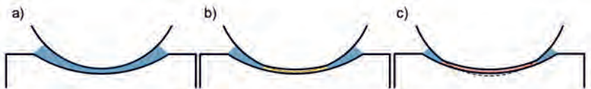
Bild 4: Wälzkontakt: a) unbelastet, b) Schmierfilm größer als Einfederung und c) Schmierfilm kleiner als Einfederung.
