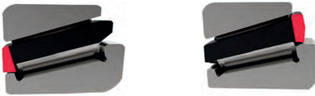
Bild 5: Käfiglösungen zur Schmiermengenregulierung: Einlass-reduziert (links), Auslass-reduziert (rechts)
