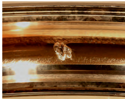
Bild 9: Testabbrechende Grübenbildung an der Außenringlaufbahn
