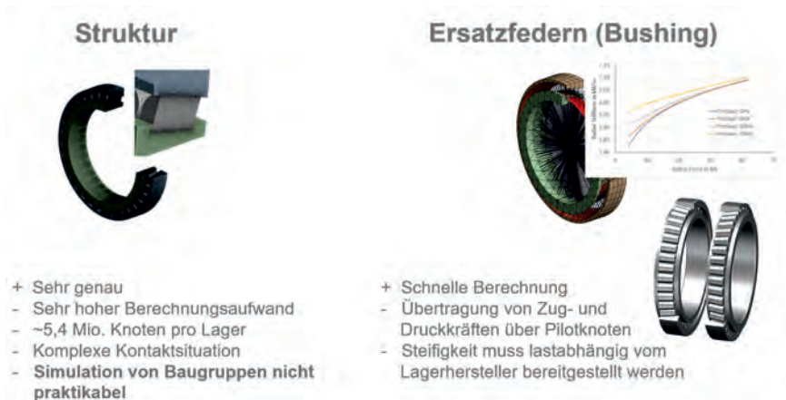
Bild 3: Gegenüberstellung der detaillierten FE-Modellierung eines Wälzlagers mit einem mit Steifigkeitskurven bedateten Ersatzfedermodell
