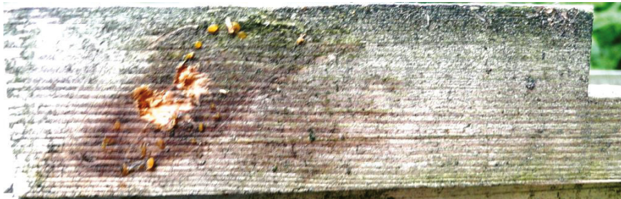
Abb. 8: Fruchtkörper von Dacrymyces spp. und Wasserflecken an einer Seitenfläche einer paraffinbehandelten Probe
