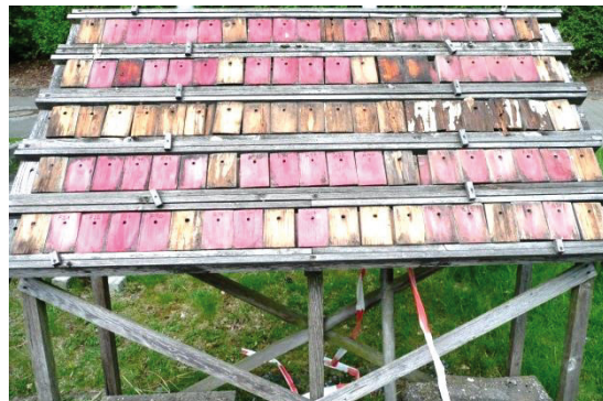
Vollständig umgedrehte Oberlage; Expositionsdauer: 81 Monate
