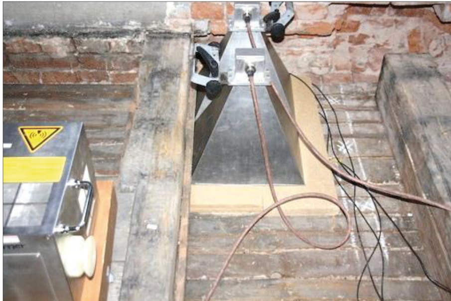
Abb. 33: Deckenoberseite in Versuch 3 mit aufgesetzten Hornstrahlantennen, Messfühler in Sparschalung eingesetzt, Abdeckung mit Holzweichfaserplatte
