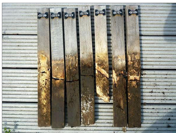
Abb. 2: Buchenhölzer nach einem Jahr Exposition im Erdkontakt am Standort Dresden, Bruch nach Schlagprüfung
