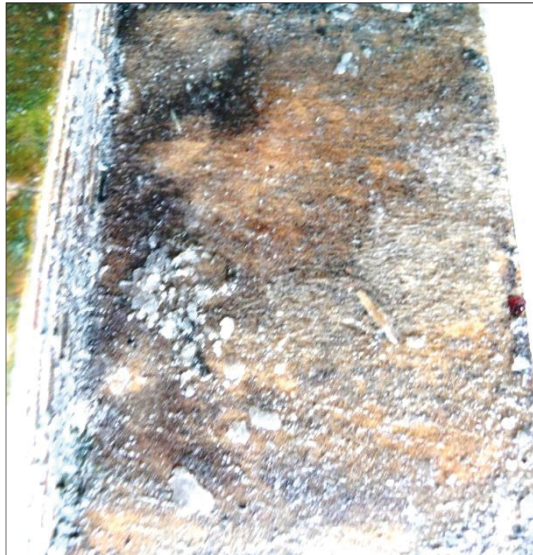
Abb. 10: Lose Paraffinablagerungen auf der unteren Lap-Joint-Hälfte
