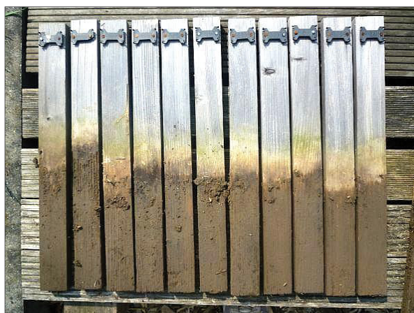
Abb. 4: Lärchenkernhölzer nach 3 Jahren, meist relativ geringe Zerstörungen (Rating 1 bis 2)
