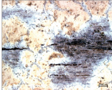
Abb. 12: Krustiger beigefarbener Fruchtkörper von Cyindrobasidium evolvens mit typischen Rissstrukturen an Kiefernholz, Bereich A, nach 12 Monaten Exposition am Standort Hamburg
