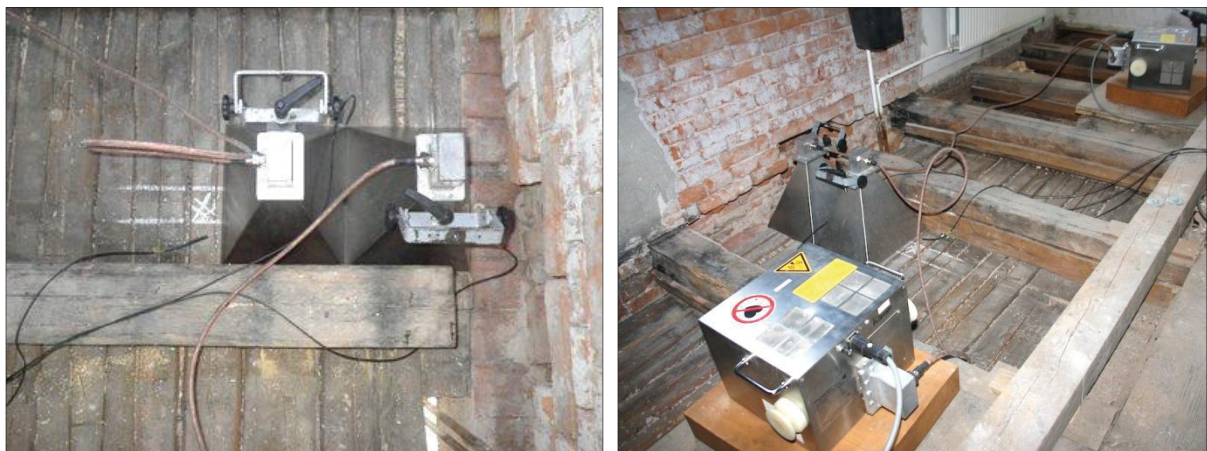
Abb. 29 und 30: Deckenoberseite in Versuch 2 mit aufgesetzten Hornstrahlantennen, Messfühler in Sparschalung eingesetzt – Behandlung der Schalung ohne zusätzliche Dämmung (Foto: Körner)
