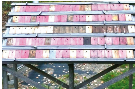
Vollständig umgedrehte Oberlage; Expositionsdauer: 27 Monate
