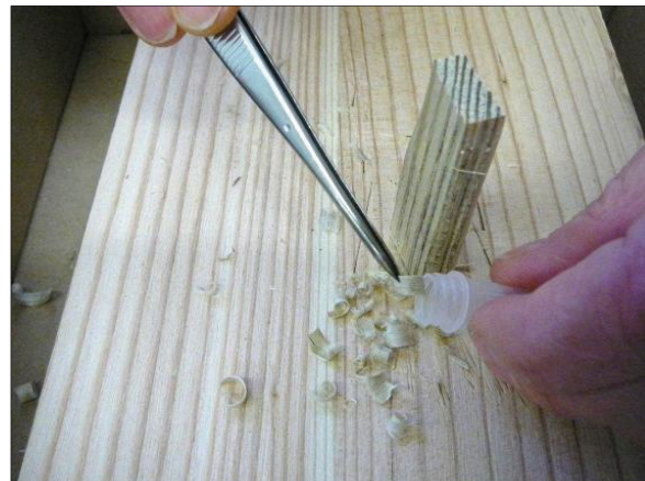
Abb. 10: Entnahme von Spänen nach Abspalten der Ränder für DNA-Untersuchungen
