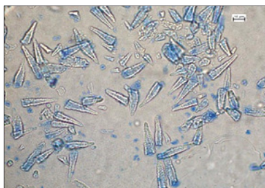
Abb. 17: Mikroskopische Aufnahme von Zystidenbruchstücken aus dem Oberflächenmyzel von Scopuloides hydroides auf Kiefersplint, Bereich B, nach 18 Monaten Exposition am Standort Hamburg
