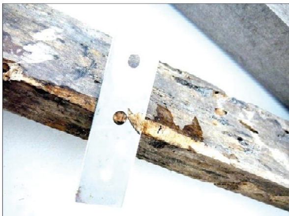
Abb. 9: Herstellung von Dünnschnitten mit scharfer Klinge für die Mikroskopie
