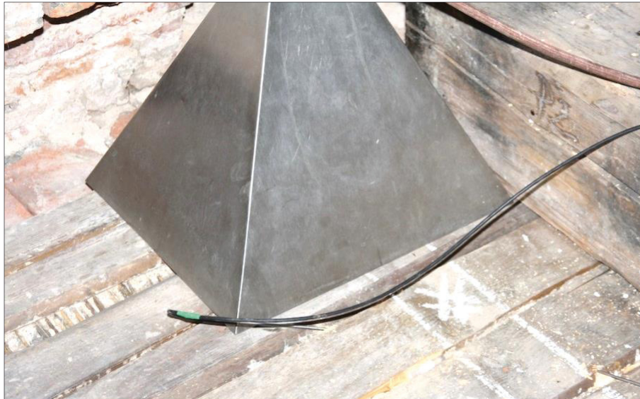
Abb. 31: eingesetzter Messfühler für die Überwachung der Temperaturentwicklung
