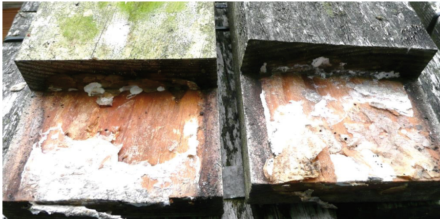
Abb. 7: Starker Pilzbefall im Lap-Joint-Bereich eines mit Paraffin behandelten Prüfkörpers
