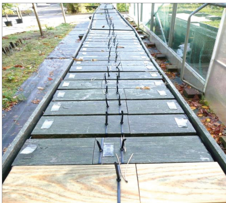
Abb. 5: Exponierte Lap-Joint-Prüfkörper. Im Vordergrund eine der im August 2009 neu eingebauten unbehandelten Kontrollproben
