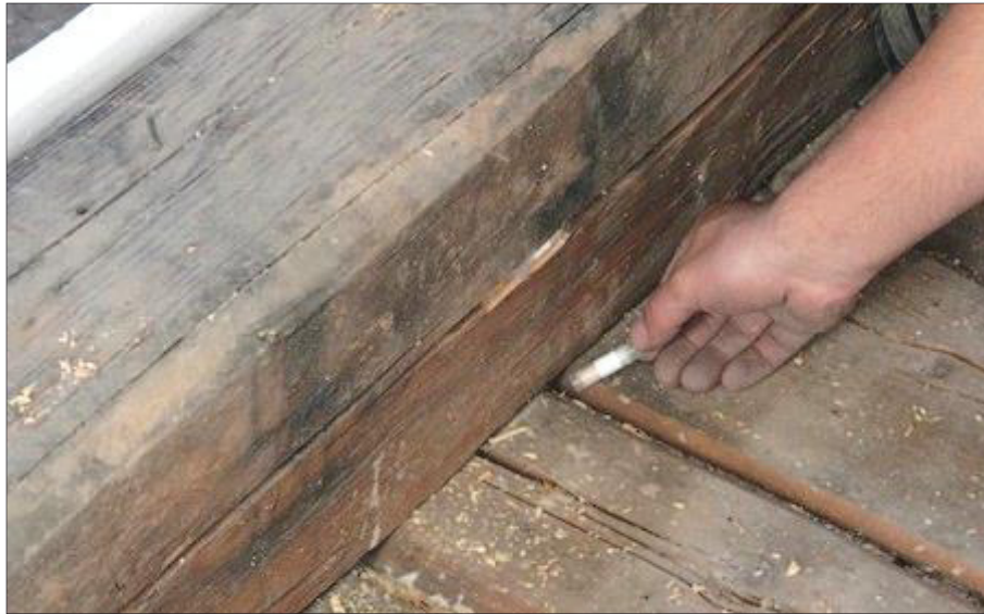
Abb. 36: Einsetzen eines Prüfkörpers aus Versuch 1 in die Fuge zwischen Deckenbalkenunterseite und Schalung (Foto: Baumann-Ebert)
