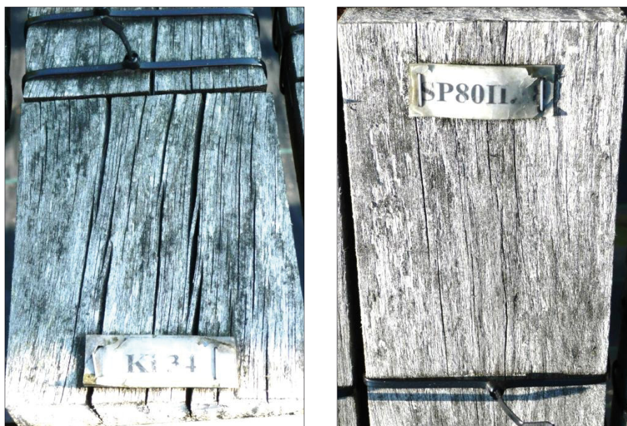
Abb. 6: Unbehandelter (links) und paraffinbehandelter Prüfkörper (rechts) nach 4-jähriger Exposition in GK 3 – Lap-Joint-Test
