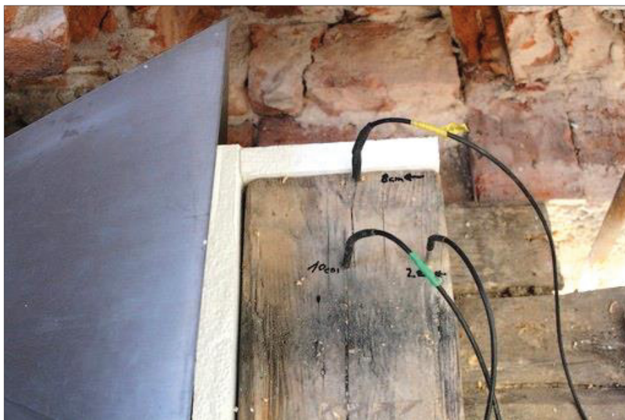
Abb. 26: Deckenbalken im Behandlungsabschnitt 1.1 mit eingesetzten Messfühlern
