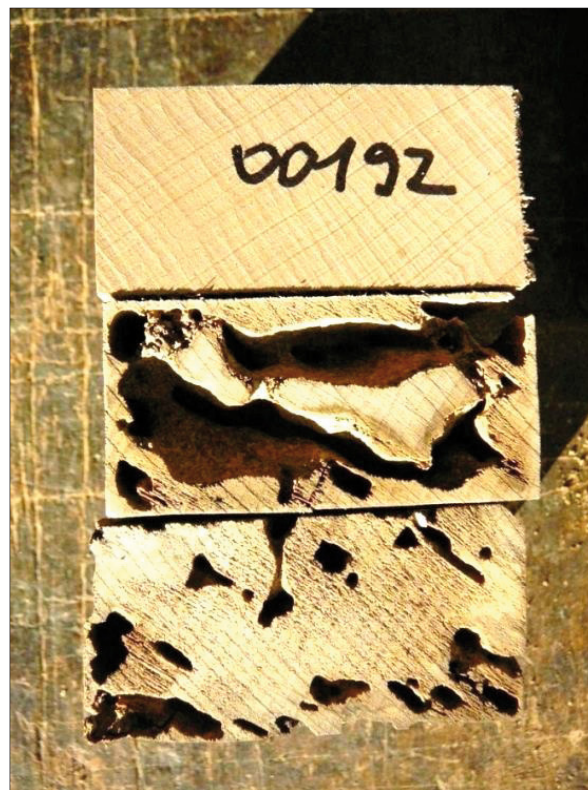
Abb. 8: Bereich A (oben), B (Mitte) und C (unten) eines Buchenholzes vom Standort Bordeaux nach 30 Monaten Expositionszeit mit Termitenfraßgängen
