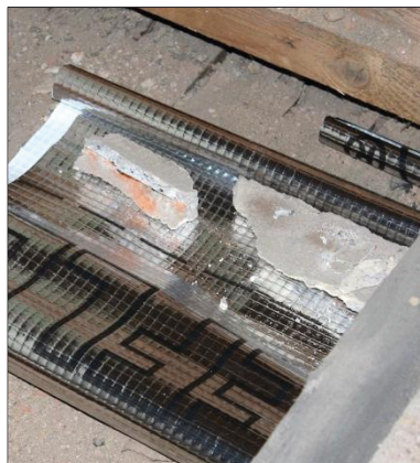
Abb. 38, 39, 40: Prüfkörper Nummer 7 und 8 verbleiben unter Baustellenbedingungen im Laufe der Versuchsreihe außerhalb des Behandlungsfeldes
