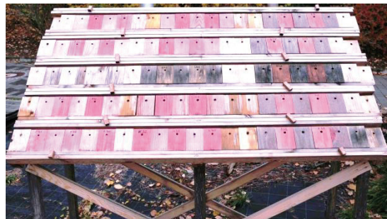
Alternierend umgedrehte Oberlage; Expositionsdauer: 3 Monate
