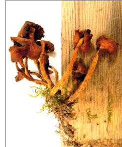
Abb. 13: Fruchtkörperbüschel von Hypholoma fasciculare an Kiefernholz im Bereich B nach nur 6 Monaten Exposition am Standort Hamburg
