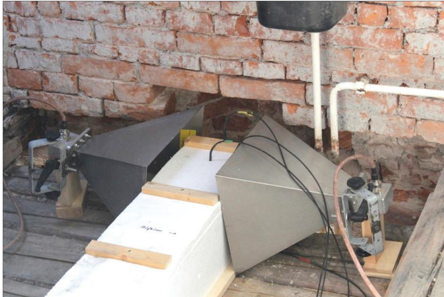
Abb. 28: Deckenbalken im Behandlungsabschnitt 1.1 mit seitlich angeordneten Hornstrahlantennen und dreiseitiger Wärmedämmung
