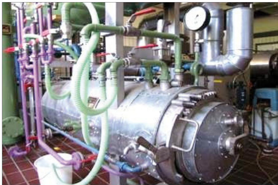
Abb. 2: Kesseldruckanlage im Technikum des Thünen-Instituts für Holzforschung
