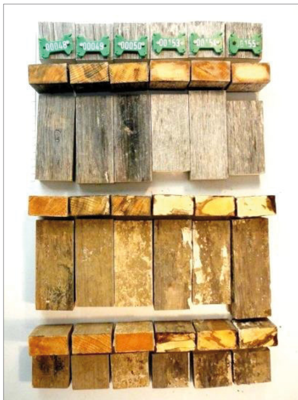
Abb. 7: Visuelle Beurteilung des Pilzbefalls an Querschnitten von Prüfhölzern in den verschiedenen Bereichen A (oben), B (Mitte) und C (unten) nach Aufschnitt
