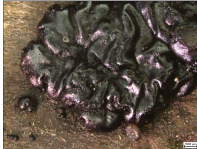
Abb. 11: Glänzender schwarzer zäher Fruchtkörper von Exidia glandulosa mit gelatineartiger Konsistenz an Rotbuchenholz, Bereich A, nach 24 Monaten Exposition am Standort Dresden
