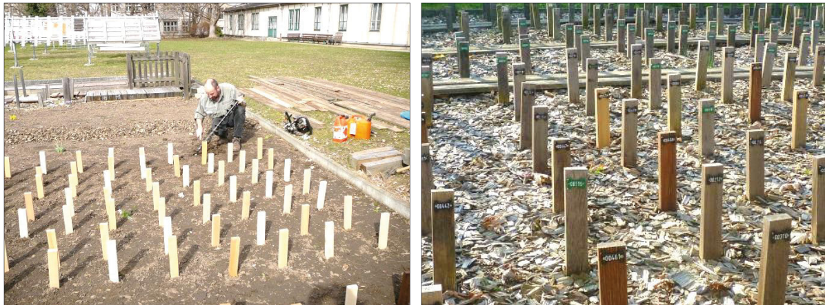
Abb. 1: Im Erdkontakt exponierte Versuchshölzer am Standort Dresden, während des Einbaus (links) und nach erfolgter Abdeckung des Prüffeldes mit Hackschnitzeln (rechts)
