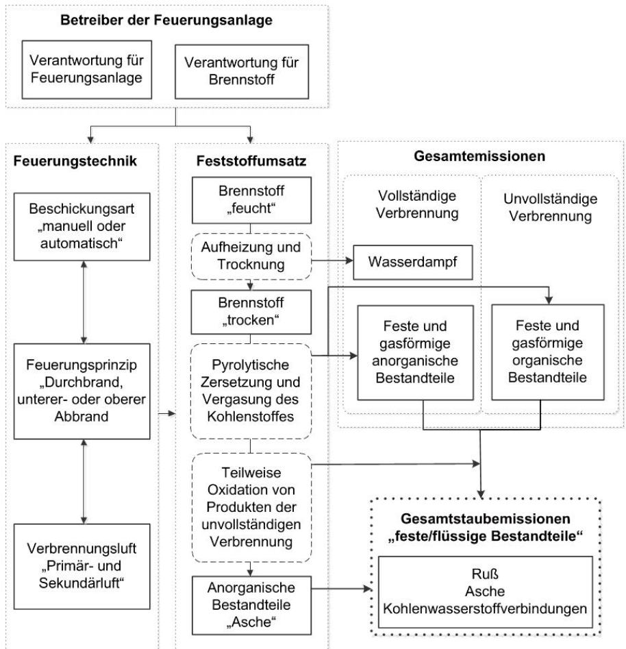
Abbildung 3.4: Einflussfaktoren auf die Entstehung von Gesamtstaubemissionen bei der Verbrennung von festen Brennstoffen, zusammengestellt nach [14]
