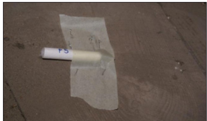
Abb. 26: Zellstoffhülse mit Hausschwammmycel
