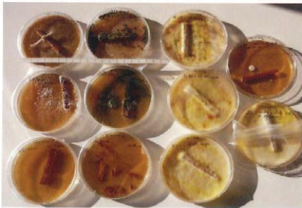
Abb. 2: Prüfsätze nach 4 Wochen Inkubation; Proben 20 bis 25 (behandelte Proben ohne Auskemmung von Serpula lacrymans jedoch größtenteils mit Schimmelpilzbefall); Proben 26 und 27 (unbehandelte mitgeführte Kontrollen) sowie Proben K 20 bis K 31 (beim Auftragnehmer verbliebene Kontrollen).
