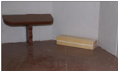
Abb. 25: Holzkörper mit Insektenlarven der MPA Eberswalde
