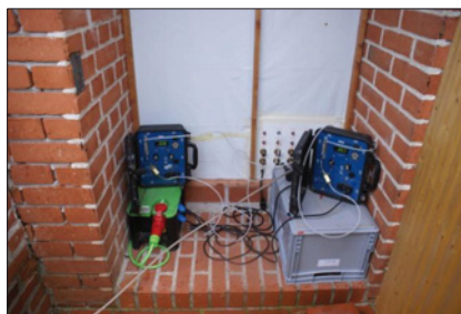
Abb. 28: Messgeräte für Konzentrationen > 150 g/m 3 , Kirche Kletznick
