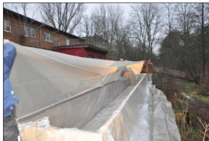
Abb. 31: Vorbereitung der mobilen Begasungskammer
