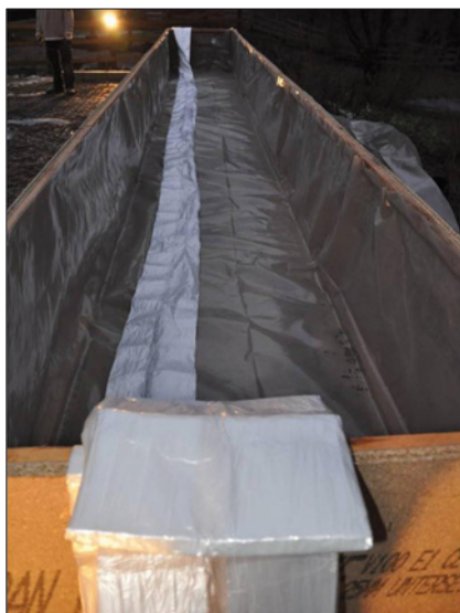
Abb. 32: Mobile Begasungskammer unmittelbar vor der Beschickung
