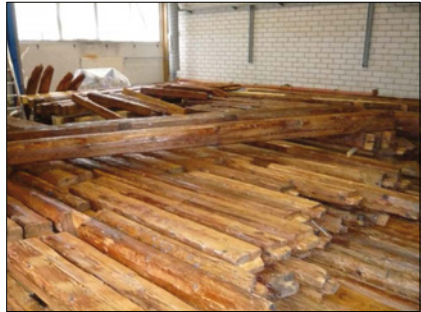
Foto 17: In einem vollständig raumluftechnisch abgeschotteten Bereich wurde ca. 1/3 der dekontaminierten und maskierten Hölzer über mehrere Wochen eingelagert und die Abgabe der Schadstoffe an die Raumluft überprüft.
