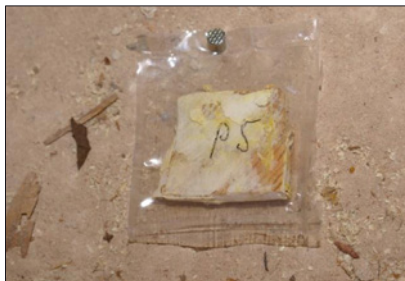
Abb. 2: Intensiv mit Substratmycel durchwachsene Kiefernholzprobe
