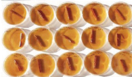
Abb. 1: Prüfsätze nach 4 Wochen Inkubation; Proben 1 bis 15: behandelte Proben ohne Auswachsen von S. lacrymans .
