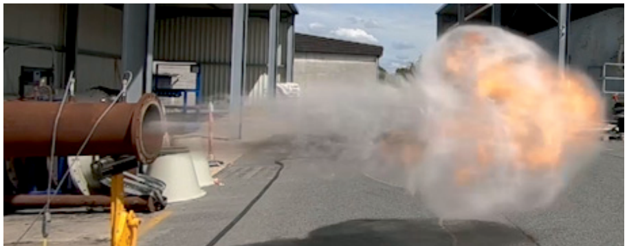
Bild 2: Ausstoß von unverbranntem Staub mit Zündung der Staub/Luft-Wolke im Außenbereich
