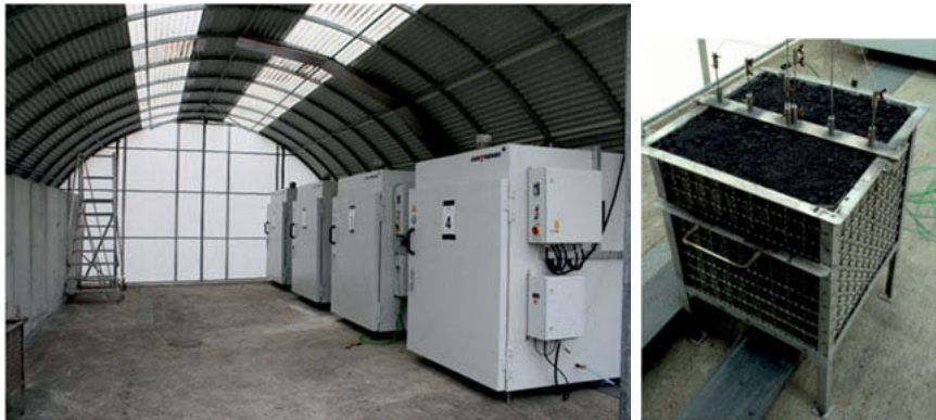
Bild 2: Wetterschutzunnel mit vier Wärmekammern für Warmlagerungsversuche (links); Instrumentierter Probenbehälter (125 dm 3 ) mit Petrolkoks (rechts)
