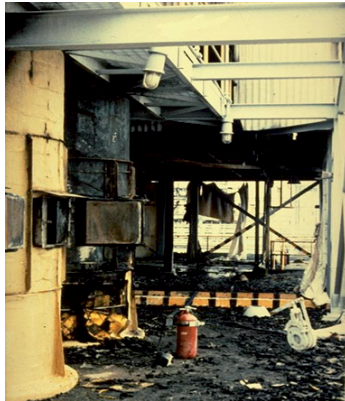
Bild 2: Nachbrand Sprühtrocknungsanlage geschützt mit Explosionsdruckentlastung
