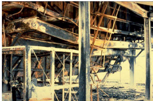
Bild 1: Brandschaden ungeschützte oder nicht richtig geschützte Absauganlage
