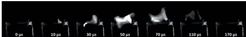
Bild 8: Zündung der Gleitfunkenstrecke mit ca. 8 J, eigentliche Brenndauer ca. 50 µs
