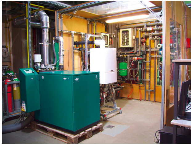
■ Abb. 90: Mikro-KWK-System am Prüfstand
