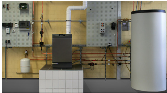
■ Abb. 36: Testbetrieb eines Stirling-Motors
