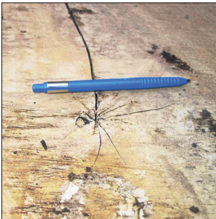
Abb. 205 (li.): Kerbbruch in einer VAE- Kunststoffbahn
