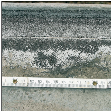
Abb. 34: Oberflächenkorrosion bei einer PVC-Bahn (sandpapierartige Oberflächenrauigkeit)
