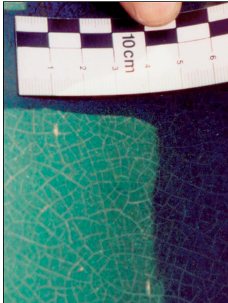
Abb. 453: Ursache der Changierung sind Glasurcra- quelés und Lichtbrechung
