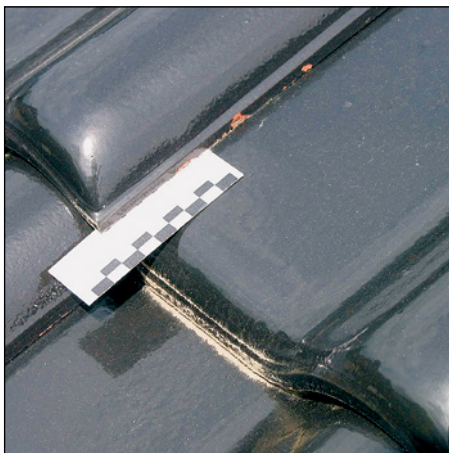
Abb. 476 (li.): Dachziegel mit üblichen Scheu- erstellen
