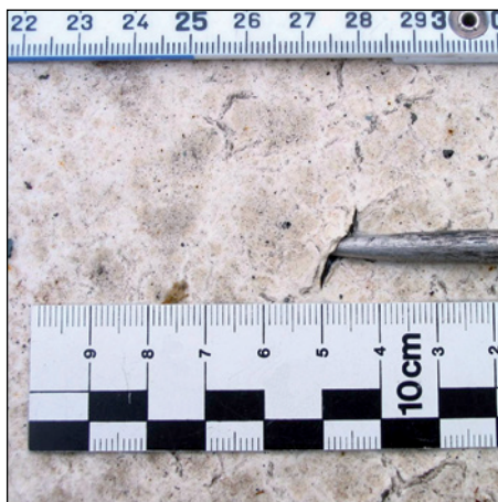
Abb. 213 (li.): Auswaschung mit Gefüge- schaden
