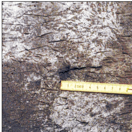
Abb. 231 (re.): Schrumpfungs- risse in PMMA- Beschichtung infolge Aus- waschung unter stehendem Wasser
