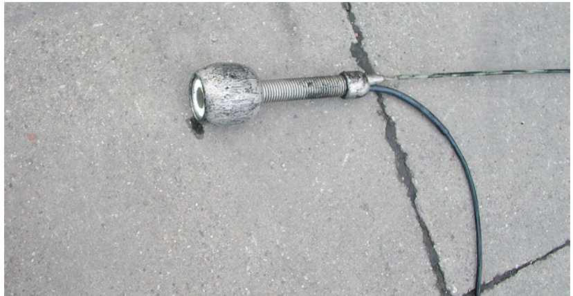
Abb. 4.27: Abwasserkamera- kopf; damit können Abwasserrohre unter- sucht werden.
