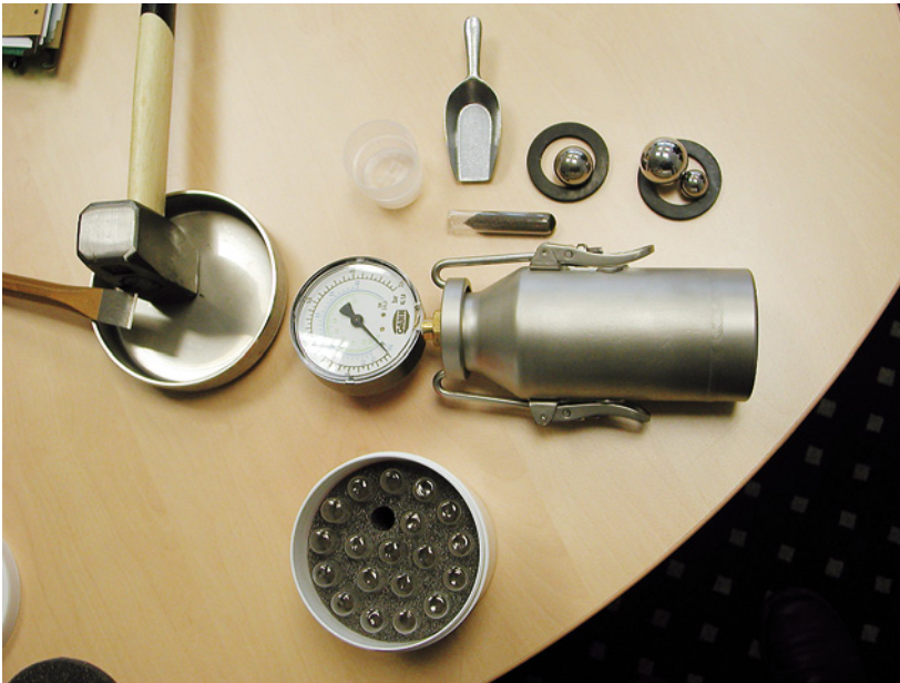
Abb. 4.10: CM-Messgerät. Für die Probenahme erforderliche Werkzeuge: Hammer und Meisel, vorgegebene Kugeln, Calcium-Carbidampullen, Feinwaage, um die Materialien genau abzuwiegen.
