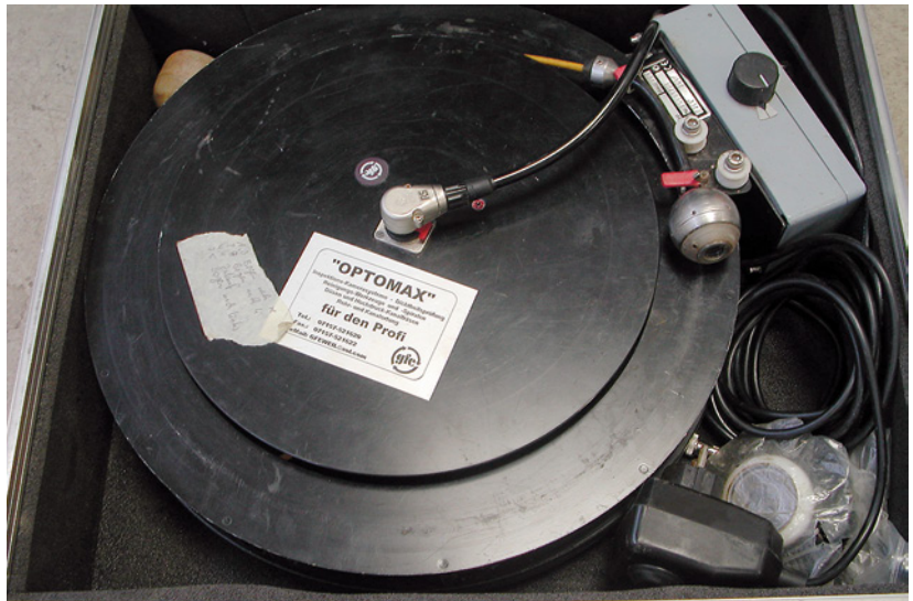
Abb. 4.28: Schiebeleitung für Abwasserrohrbefahrung
