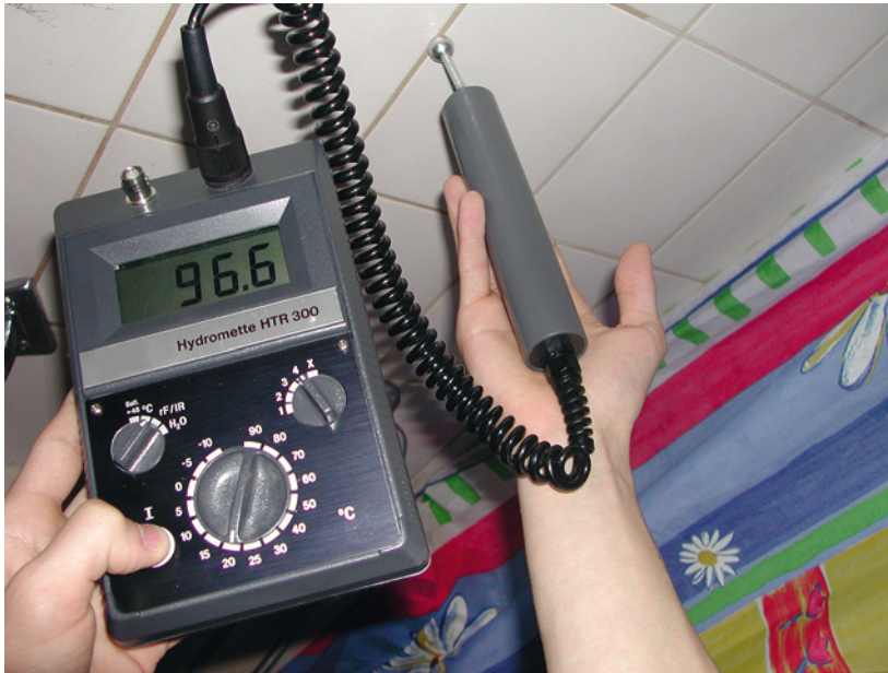
Abb. 4.2: Induktive Feuchtigkeitsmessung mit Gann (Kugelkopf). In diesem Badezimmer wurde eine Stunde vorher geduscht
