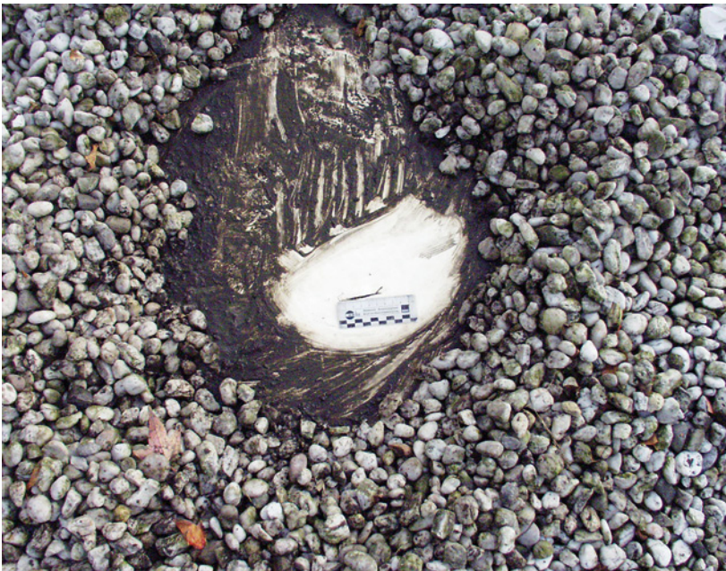
Abb. 4.42: Georteter Riss in der Abdichtung [Foto: Trotec oHG, Heidelberg]
