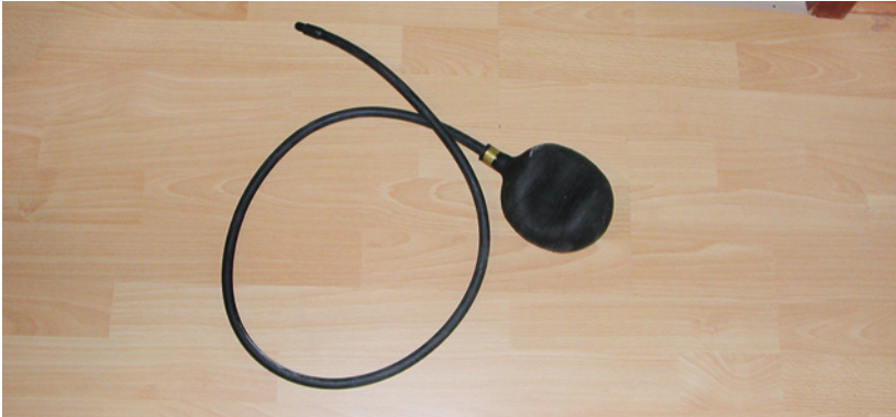
Abb. 4.30: Blase zum Abdichten eines Abwasserrohres. Sie wird in das Abwas- serrohr gesetzt und aufgeblasen. Dadurch kann Wasser angestaut und einzelne Abschnitte können auf Dichtigkeit geprüft werden.
