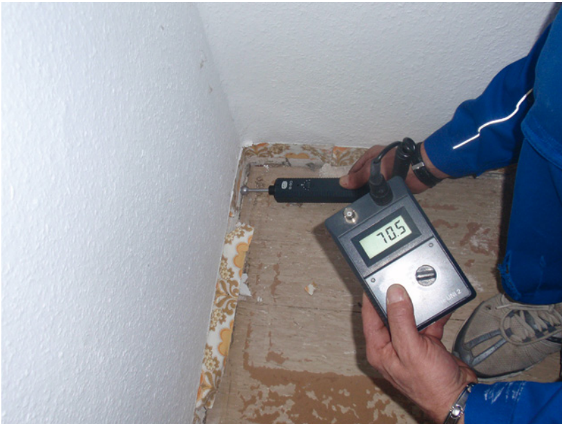
Abb. 4.43f: Messung schräg in die Ecke nicht zulässig: 70,5 Digits. Das Messergebnis wird durch Messungen in die Ecke hinein negativ beeinflusst.
