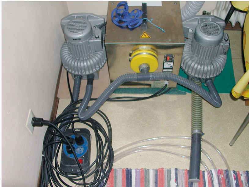
Abb. 5.10: Trocknungseinheit Adsorptionstrockner mit zwei Seitenkanalverdichtern
