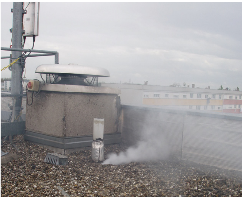
Abb. 4.38: Rauchaustritt an der Bruchstelle einer Flach- dachabdichtung unter der Kiesschicht
