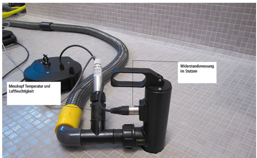
Abb. 5.21: Messeinheit für die Dämmschichtkontrolle b: im eingebauten Zustand
