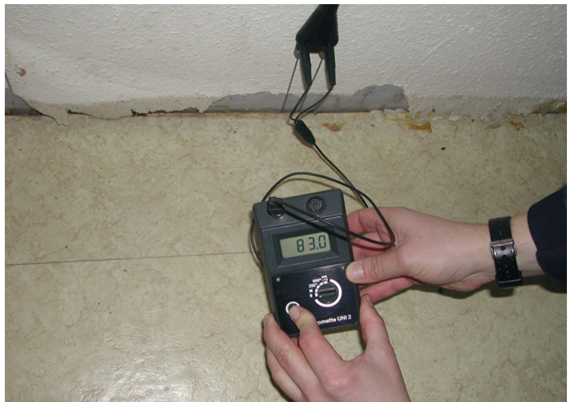
Abb. 4.4: Widerstandsmessung mit GANN (Rand- messung des Zement- estrichs mit Gabel, kei- ne isolierten Nadeln!)
