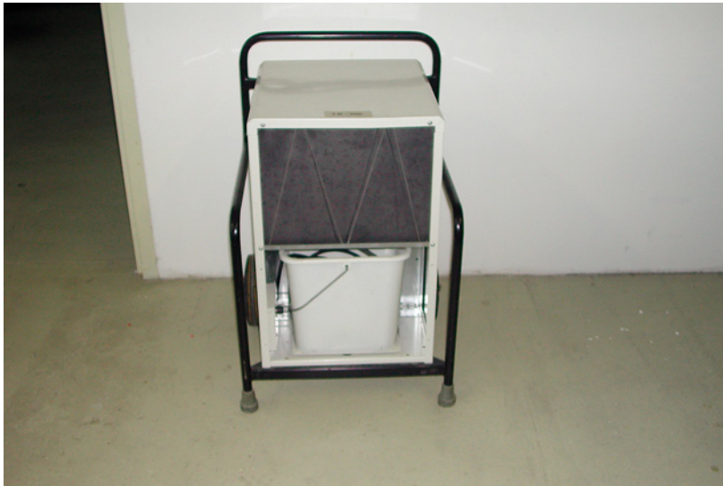
Abb. 5.3: Kondensationstrockner Rückseite; hier wird die Raumluft angesaugt und die Feuchtigkeit (Kondenswasserbildung auf den Lamellen) wird in dem Wassereimer aufgefangen. Dieser muss regelmäßig entleert werden. Ansonsten schaltet das Gerät ab, bevor es überläuft. Diese Geräte sind meist mit einem Schwimmer im Wasserbehälter ausgestattet, der den Kondensationstrockner bei einem eingestellten Wasserstand abschaltet.
