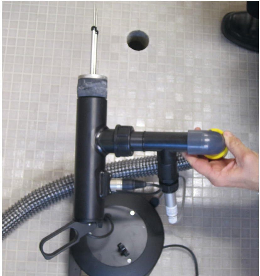
Abb. 5.21: Messeinheit für die Dämmschichtkontrolle a: Messsonde
