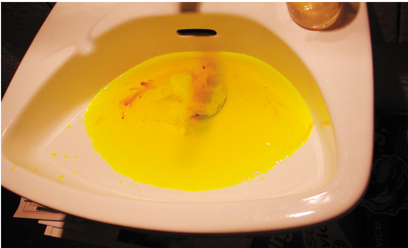
Abb. 4.35: Einsatz von Uranin – es wird über ein Wasch- becken ins Leitungsnetz gegeben.
