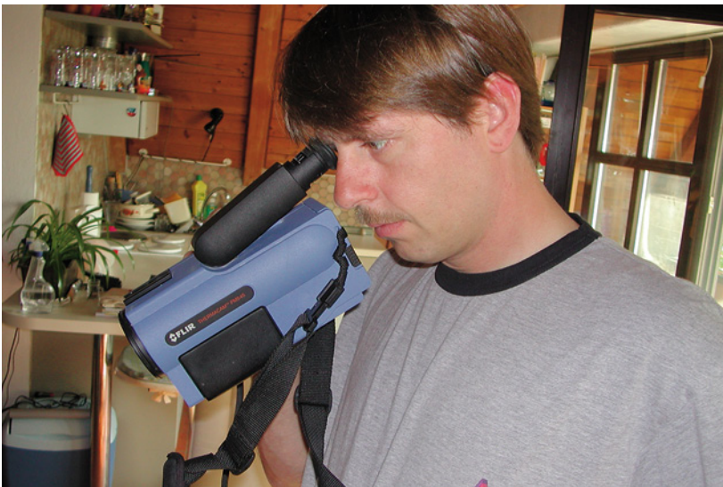
Abb. 4.17: Hier wird durch den Leckort eine Leckortung mittels Thermografiekamera durchgeführt
