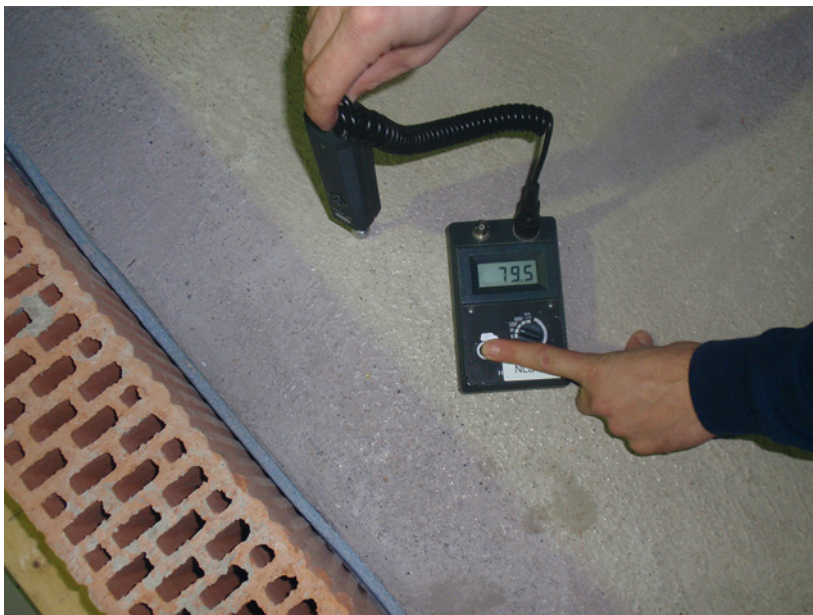
Abb. 4.3: Induktive Feuchtigkeitsmessung mit Gann (Kugelkopf) Anhydritestrich (Trocknen). Dieser ermittelte Wert ist an diesem Ort als trocken zu bezeichnen!
