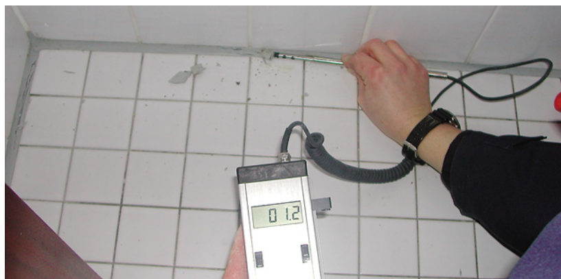
Abb. 5.56: Luftstrommessung: Luftströmgeschwindig- keit 1,2 m/s
