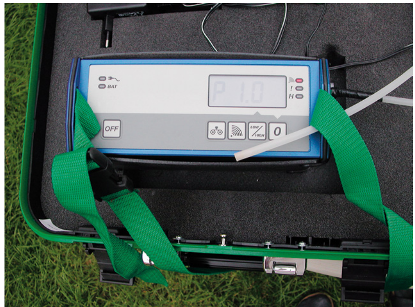
Abb. 4.23: Gasdetektor; damit wird die Konzentration des austretenden Gases ermittelt. Um die Gasaustrittsstelle genauer einzugrenzen, wird eine Glocke, die über einen Schlauch verbunden ist, angeschlossen.
