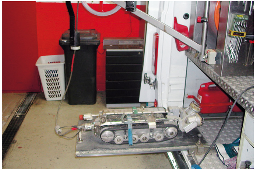
Abb. 4.33: Abwasserkameraschlit- ten für außenliegende Abwasserleitungen mit Schwenkkopf. Hier kann der vordere Kopf noch einige Meter in Abzwei- ge geführt werden.
