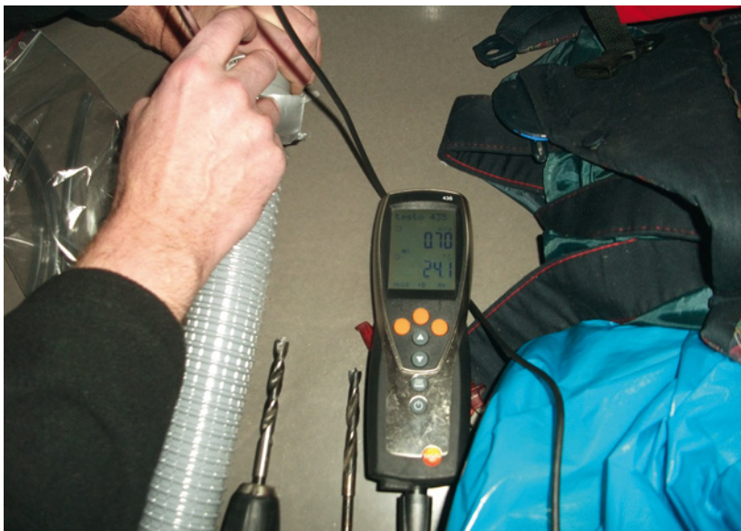
Abb. 5.16: Zu geringer Luftdurchsatz im Schlauch
