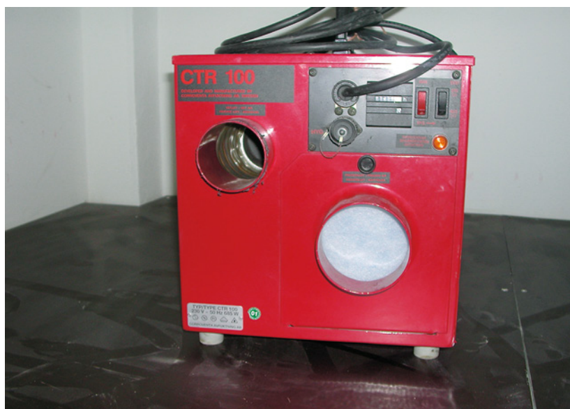
Abb. 5.5: Adsorptionstrockner: in der Ansaugöffnung muss immer ein neuer Filter eingesetzt werden.
