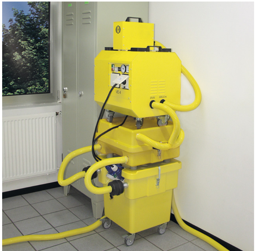
Abb. 10.13: Filteranlage bei Schimmelschaden in der Dämmschicht, nur im Unterdruckverfahren einsetzbar.
