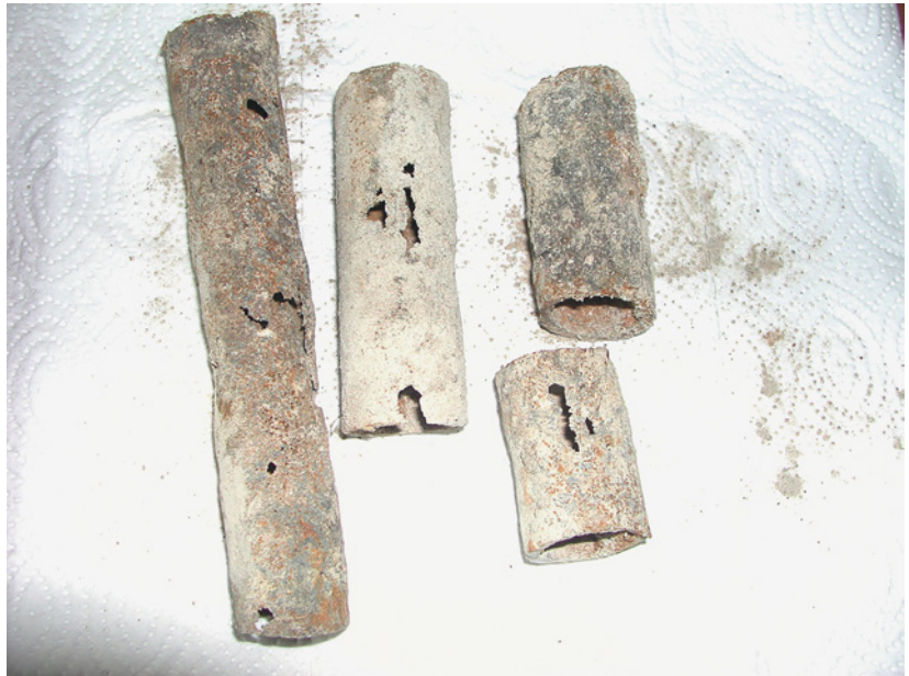
Abb. 2.42: Rohre, die direkt auf der Rohdecke aufgelegt werden, scheuern bei Temperaturänderungen und aufgrund von Eigenschwingung durch.
