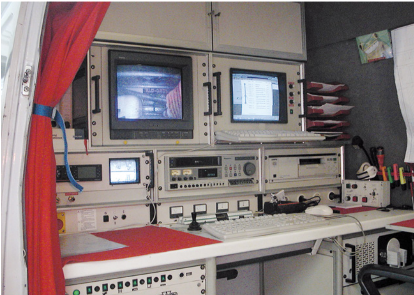
Abb. 4.31: Ein mit Kamera und Spüleinrichtung aus- gestattetes Fahrzeug; Ausstattung innerhalb des Fahrzeuges
