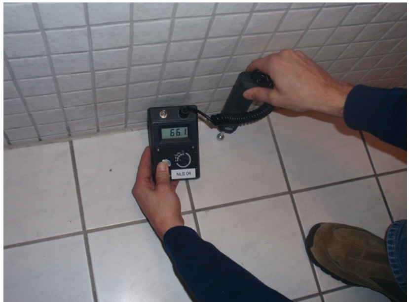
Abb. 4.43d: Messung der Boden- fliese: 66,1 Digits
