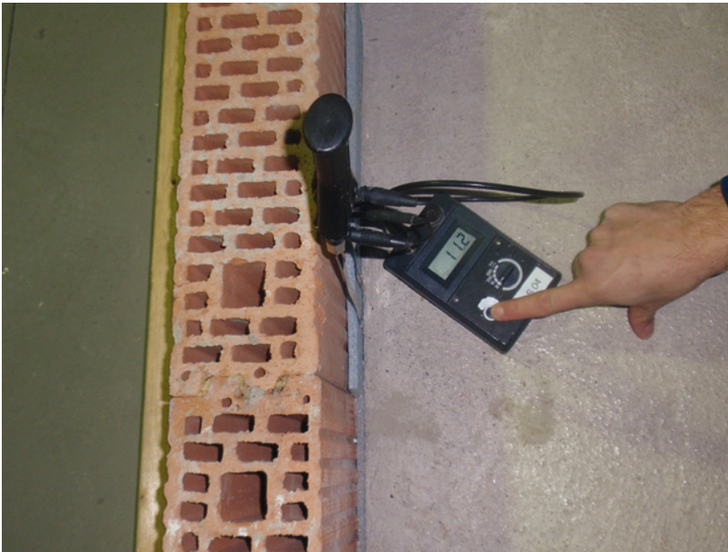
Abb. 4.5: Widerstandsmessung mit GANN (Randmes- sung des Anhydrit- estrichs mit einer Gabel)
