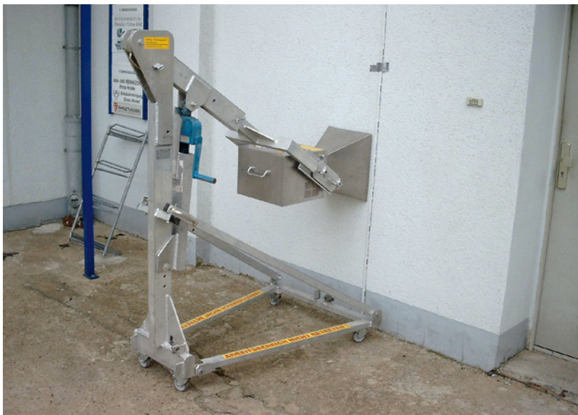
Abb. 5.8: Mikrowellengerät mit Vorrichtung zur Positionierung
