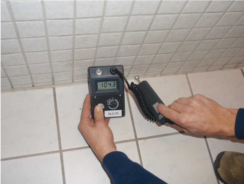
Abb. 4.43e: Messung schräg in die Ecke nicht zulässig: 104,3 Digits
