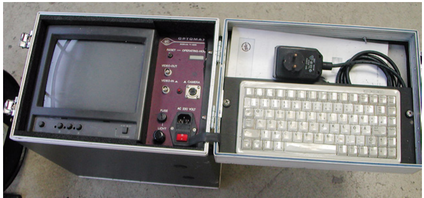
Abb. 4.29: Mobiler Kameramo- nitor mit Tastatur für Abwasserkamera. Zur Dokumentation der vorgefundenen Situation; wird meist bei im Gebäude verlegten Leitungen bis DN 100 eingesetzt.
