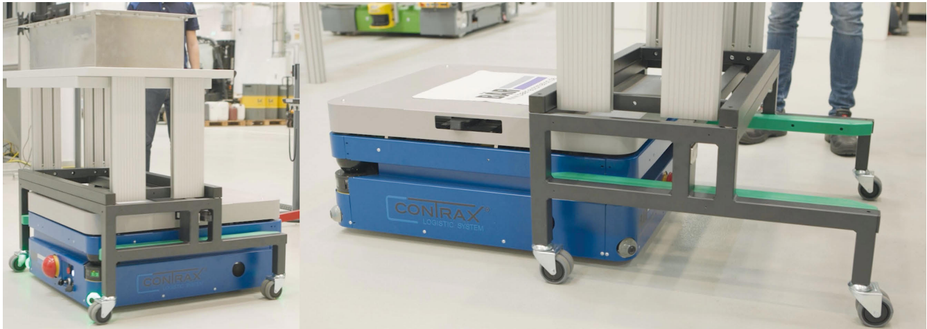
Bild 4. FTS (fahrerlose Transportsysteme) mit entwickeltem Adapter zur Aufnahme des Arbeitstisches. Foto: WZL | RWTH Aachen University
