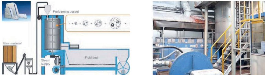
Bild 5: Prinzip des dampfbasierten Vor-/Weiterschäumens von EPS (links) [8] sowie großer Dampfverschäumer zur industriellen Serienproduktion von EPS-Halbzeugen für die Gebäudedämmung (rechts) [9]
