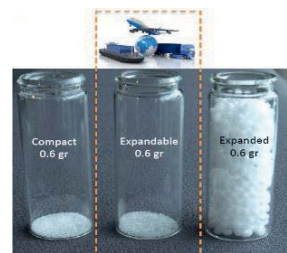
Bild 16: CO 2 -Emission bei der Rohmaterialproduktion verschiedener Werkstoffe (links) [18] sowie Volumenvergleich von (un-)beladenem PS-Mikrogranulat mit vorexpandierten EPS-Schaumperlen (rechts) [4]
