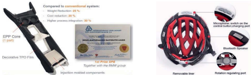
Bild 13: Ausgezeichnete Gemeinschaftsentwicklung einer durch Einlegekomponenten im Formschaumen funktionsintegrierten Mittelarmlehne (spritzgegossene PP-Teile, umgeformte TPO-Folie und EPP-Kern, links) [4] sowie neuartiger Fahrradhelm mit EPS-Korpus, PC-Außenschale und vielen Funktionselementen [16]
