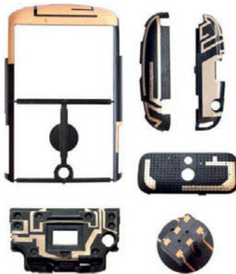
Bild 1: Beispiele für 3D-MID Bauteile im Bereich der Kunststoffverarbeitung [2].
