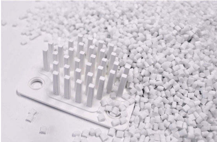
Bild 3: Probekörper "Kühlkörper" zur Ermittlung des Verarbeitungsverhaltens von wärmeleitenden Kunststoffen aus thermo- und duroplastischen Werkstoffen im Hause RF Plast GmbH
