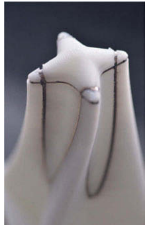
Bild 8: Gedruckte Leiterbahn in einem gefrästen Graben (Silber auf FDM PLA)
