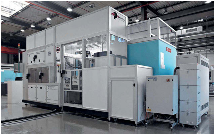
Bild 4: Umsetzung des Konzepts an einer Systec Servo 210 (2.100kN) zur Produktion von dekorierten Touch-Displays
