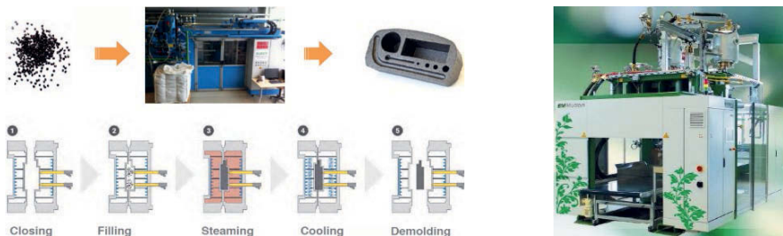
Bild 6: Prinzip des dampfbasierten Formschäumens von Partikelschäumen am Beispiel einer automobilen Bordwerkzeughalterung aus EPP (links) [4] sowie aktueller Formteilautomat für die industrielle Serienproduktion (rechts) [10]
