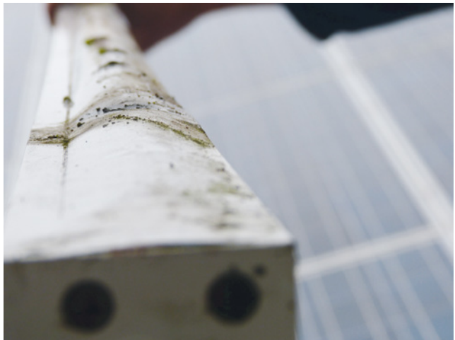
Bild 91: Frostschaden an Rahmen
