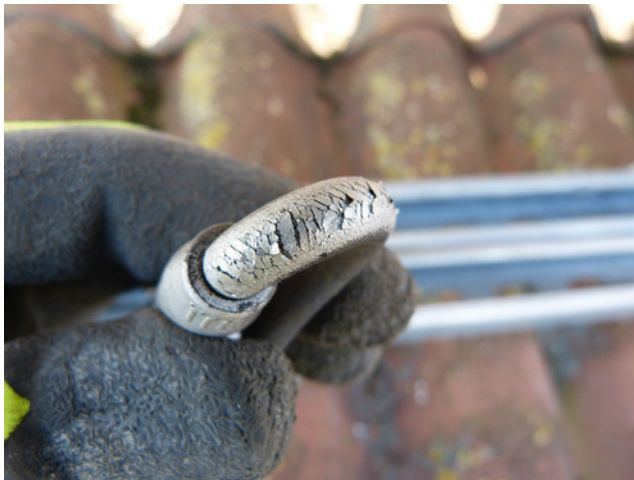
Bild 69: UV-Schädigung an einer ungeschützten Leitung
