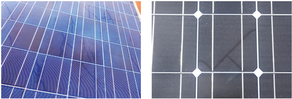
Bild 88: Schnecken Spuren mit Detailaufnahme eines anderen Moduls
