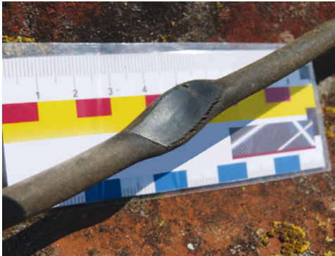
Bild 67: durch Modulrahmen gequetschte Leitung
