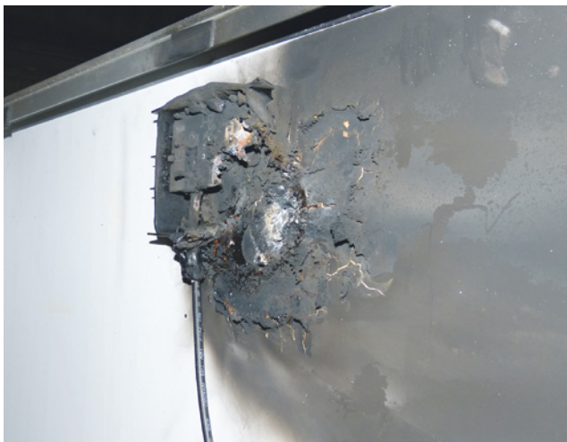
Bild 101: verbrannte Modulanschlussdose (Fabrikat Scheuten)
