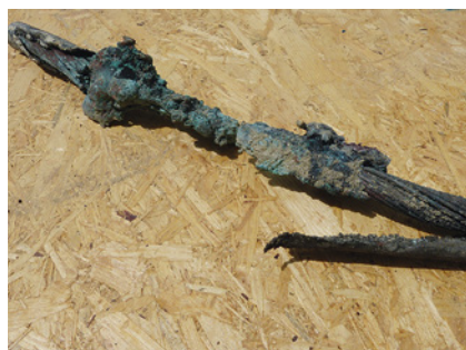
Bild 64: provozierte Lichtbogen an zwei offenen Kabelenden (simuliert z. B. abgerissene Leitung) von einem String mit ca. 2,2 kWp (links), durch Lichtbogen zerstörte Generatorhauptleitung (240 mm 2 Kupfer) mit ausgeprägter Kupferschmelze (rechts)
