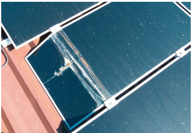
Bild 95: Glasbruch an Glas-Glas-Laminat
