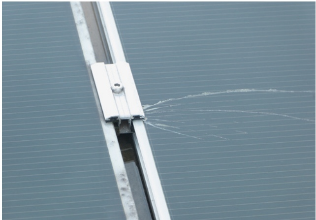
Bild 94: Glasbruch an Klemmverbindung
