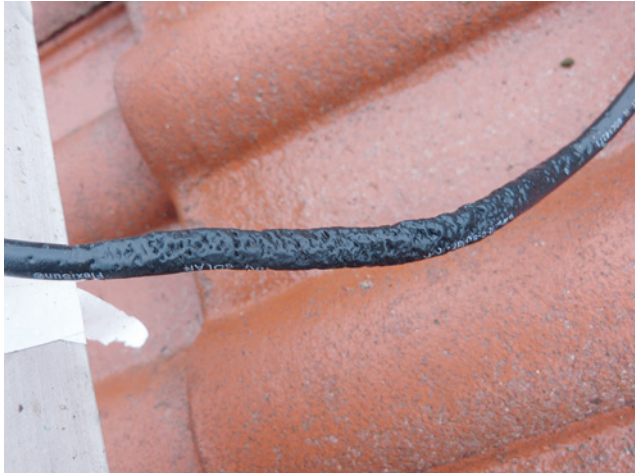
Bild 77: typischer Verbisschaden eines Marders
