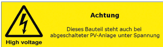
Bild 111: Kennzeichnungsschild z. B. auf Generatoranschluss- kästen oder Freischaltern
