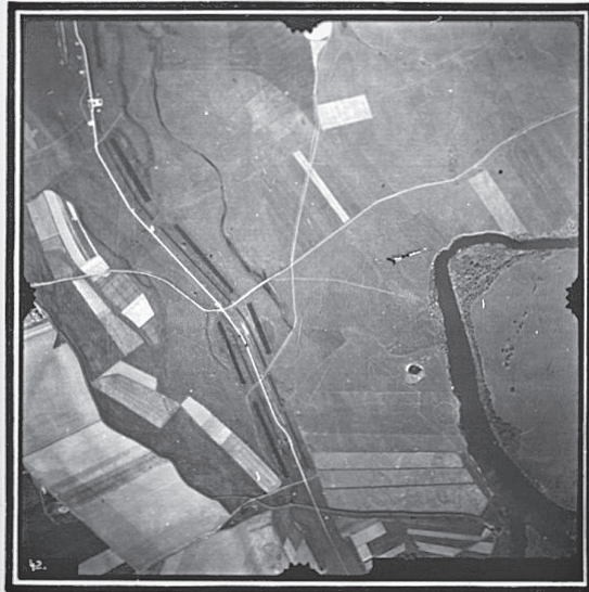
Original-Senkrechtaufnahme einer 18/18 cm Reihenbildkammer m. 21 cm Brennweite im ungefähren Maßstab 1:8300. Also aus ca. 1750 m Flughöhe.
