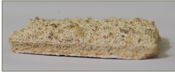
Bild 54: Ablösung an der nicht gefestigten, immer noch sandenden Original-Putzschicht
