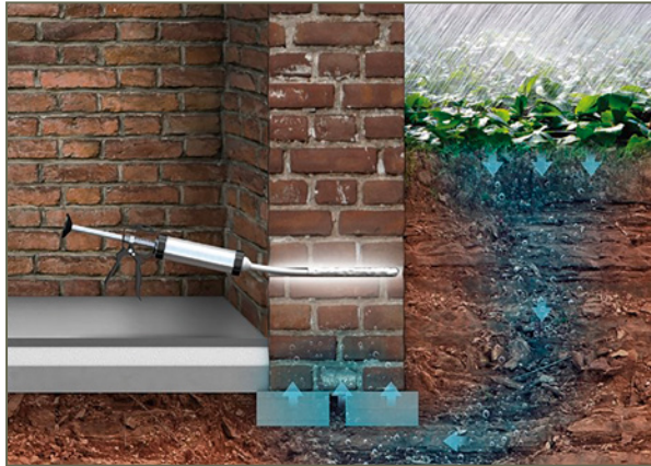
Bild 37: Schematische Darstellung des Einspritzens der hydrophobierenden Injektionscreme in den Mauerwerksquerschnitt
