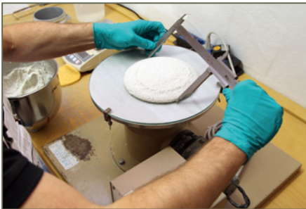
Bild 21: Prüfung des Ausbreitmaßes am Frischmörtel
