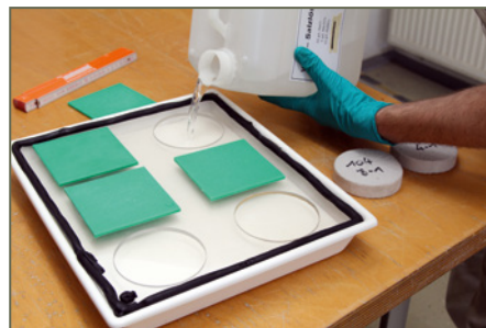
Bild 24: Im gesamten Prüfzeitraum wird so viel Salzlösung nachgegeben, dass die Scheibenunterseite ständig benetzt ist.
