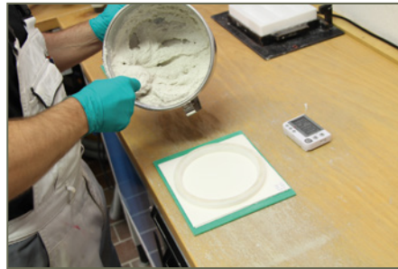
Bild 20: Vorbereitung zur Prüfung des Wasserrückhaltevermögens
