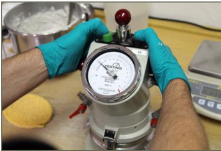
Bild 19: Prüfung des Luftporengehaltes am Frischmörtel
