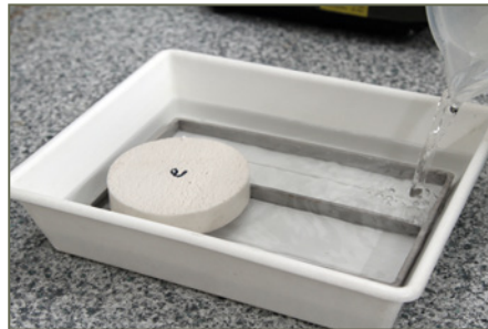
Bild 22: Prüfung der kapillaren Wasseraufnahme am Festmörtel
