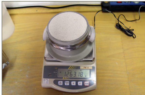
Bild 57: Überprüfung der Frischmörtelrohddichte mit einer Waage.
