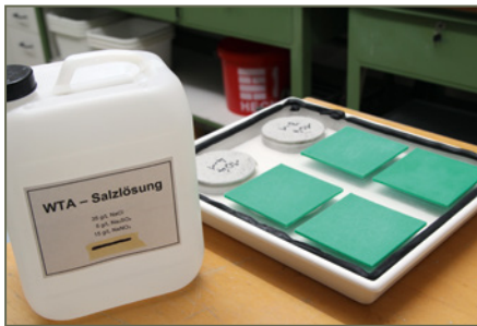
Bild 23: Prüfung der Salzresistenz am Festmörtel mit WTA-Salzlösung
