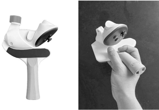
Abb. 69–70: Controllermodifikationen für die Meta Quest 3
