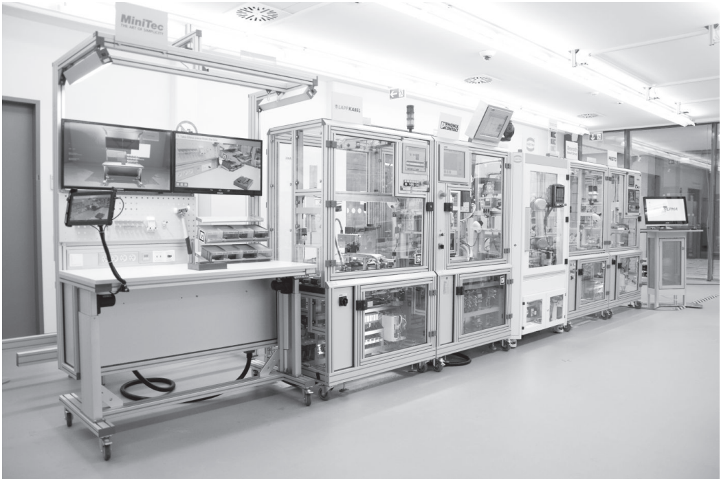
Abbildung 2: Test- und Demonstrationsanlage der Technologie-Initiative SmartFactory KL e.V. mit den herstellerepezifischen Produktionsmodulen
