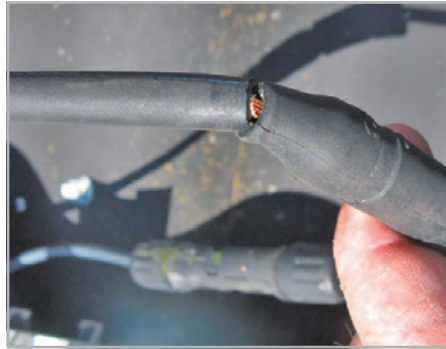
Abb. 804: Brand einer PV-Anlage
