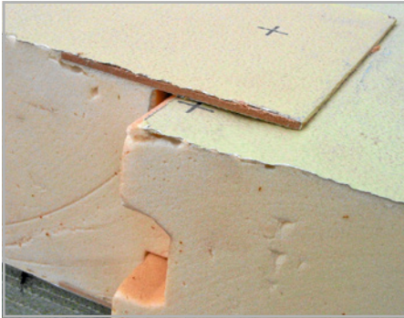
Abb. 238 und 239: Falzfugen, Anschlussfugen, und Stoßfugen aus Platten-schnitten sind unvermeidbar und wirksame Leiter für Luft-, Dampf- und Schalldurchgang.
