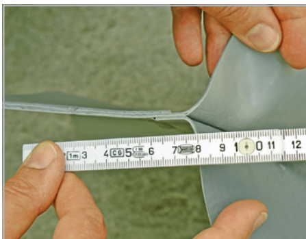
Abb. 463 und 464: Unvollständige Schweißnähte
