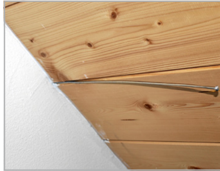
Abb. 190: Luft- und dampf- undichtes Dachge- schoss im Prüf- nebelversuch
