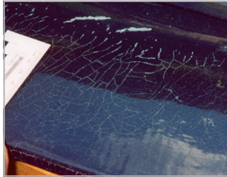
Abb. 372 und 373: Scheinbare Farbabweichung durch Salzausblühung
