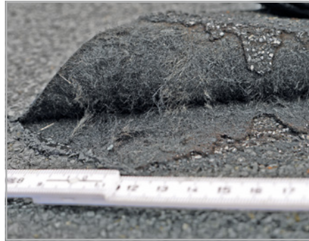
Abb. 812 und 813: Unvollständig imprägnierte (getränkte) Bitumenschweißbahn: Die Bahn lässt sich aufschälen und ist nicht ausreichend wasserfest.
