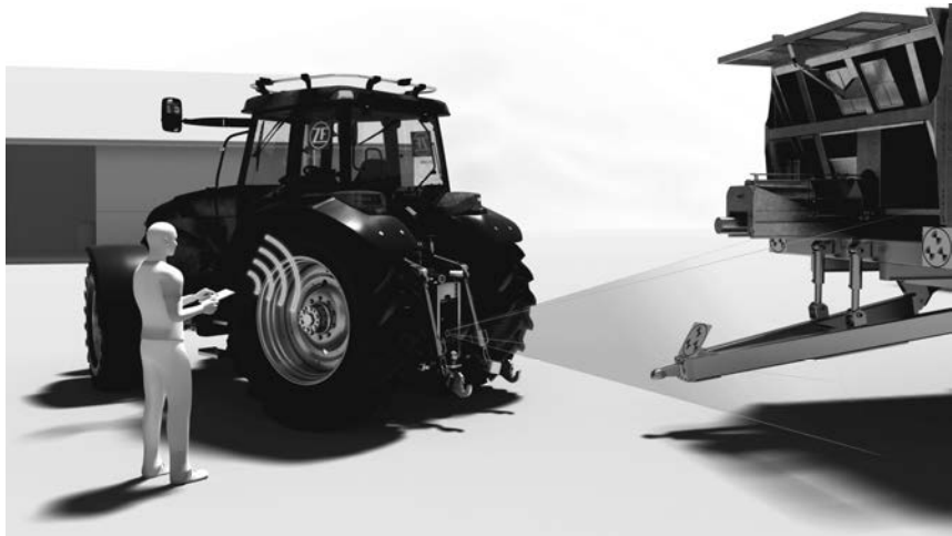
Bild 3: Automatisches Rangieren für das Ankoppeln mit der Funktion Hitch Detection
