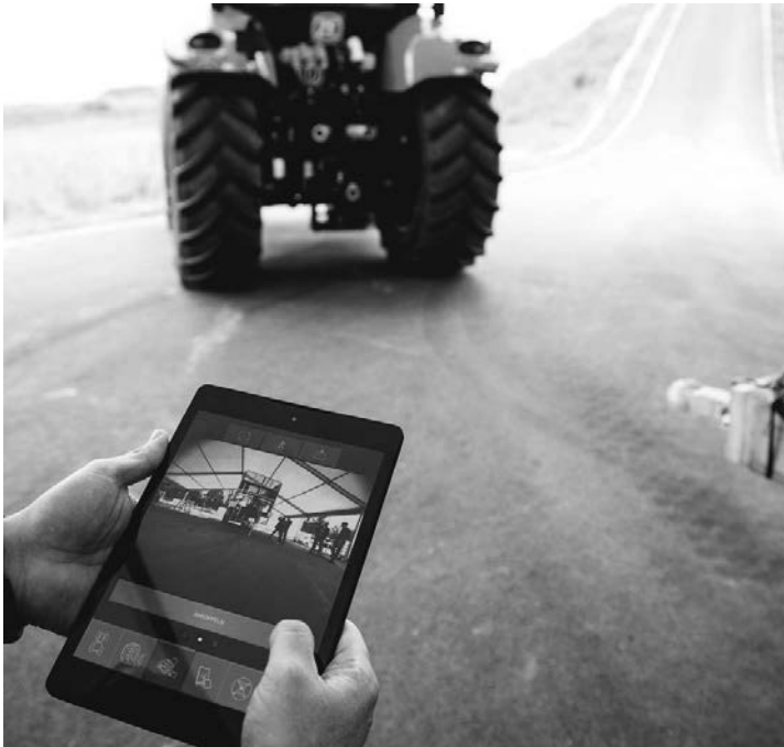
Bild 2: Ansteuerung der automatisierten Rangierfunktionen über das HMI (Tablet)
