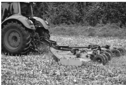
Bild 3: Mulchsysteme mit vertikaler (links) und horizontaler (rechts) Werkzeugachse (Sichel- und Schlegelmulcher) [Fotos: A. Grosa, TU Dresden, AST]
