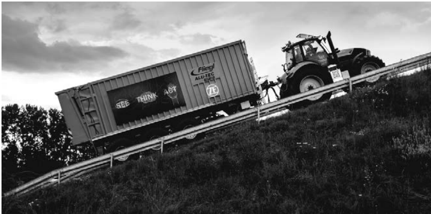
Bild 4: Extreme Steigungsfahrt mit Hilfe des optimalen elektrischen Traktionsmanagements
