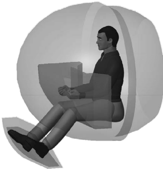
Bild 4: 3D-Modell der Reichweiten- und Bequemlichkeitsbereiche aus DIN EN ISO 6682 mit mittlerem Maschinenführer aus DIN EN ISO 3411
