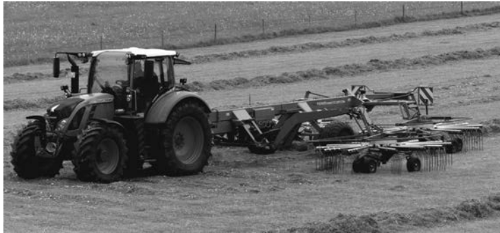
Bild 4: Elektrisch betriebener Vierkreiselschwader im Feldtest
