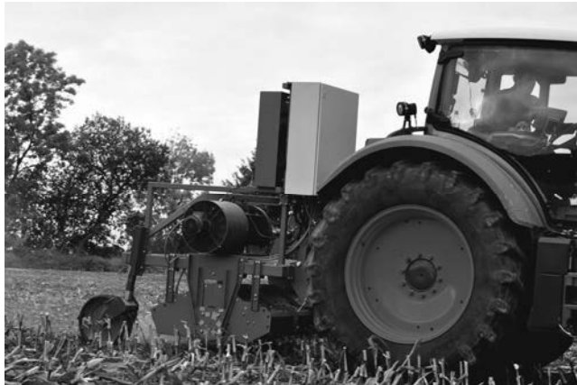
Bild 7: Versuchsmulcher, in Drehzahl und Gehäuse variabel, mit elektrischem Antrieb [Foto: A. Grosa, TU Dresden, AST]
