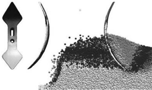
Bild 8: Digitalisiertes Grubberschar und Modell für den Arbeitsprozess
