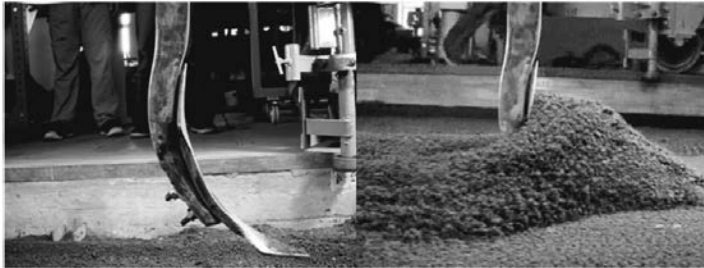
Bild 6: Grubberscharversuch in der Bodenrinne des AST/ TU Dresden
