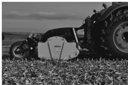
Bild 3: Mulchsysteme mit vertikaler (links) und horizontaler (rechts) Werkzeugachse (Sichel- und Schlegelmulcher) [Fotos: A. Grosa, TU Dresden, AST]
