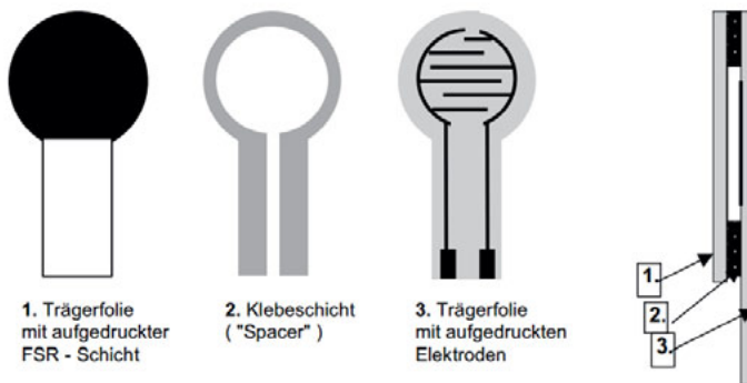
Abbildung 5.5 Aufbau der FSR-Sensoren (Interlink 2009)
