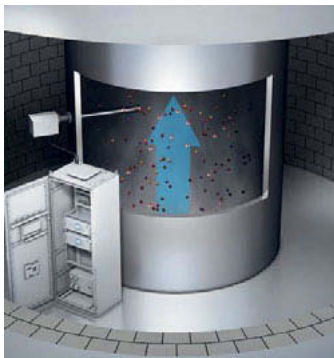
Bild 1: kontinuierliche Emissionsmesseinrichtung mit extraktiver Probenahme 2
