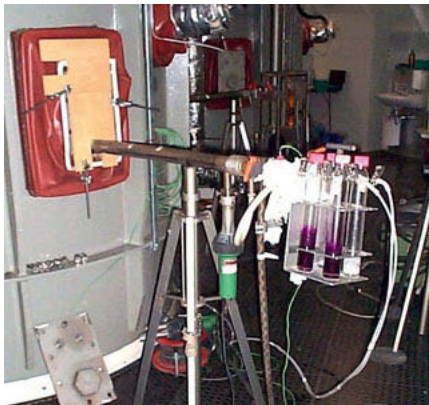
Bild 3: Manuelle Quecksilbermessung nach DIN EN 13211
