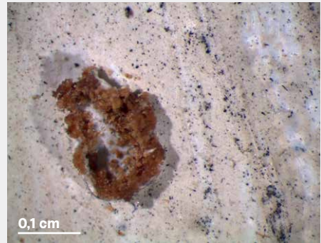
Abb. 5.10 Detail Schadensbild (Stereomikroskop). Die Malschicht bildet um den Krater eine Begrenzung, indem sie – durch das austretende Material plastisch deformiert – eine Art Kranz bildet. Dieses Phänomen ist an vielen Kratern festzustellen, manchmal bildet die Malschicht auch kleine Dächer, die vom austretenden Material weggeschoben werden. Es weist darauf hin, dass die Malschicht in noch nicht getrocknetem Zustand bereits deformiert worden ist. Im Bereich der Malschichtdeformationen sind vielfach Risse und Malschichtausbrüche vorhanden. Die Konglomerate lagern sich an der Innenseite der Kraterwände an.
