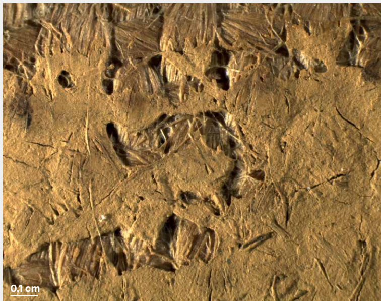
Abb. 2.11 Detail Schwindrisse (Stereomikroskop).
