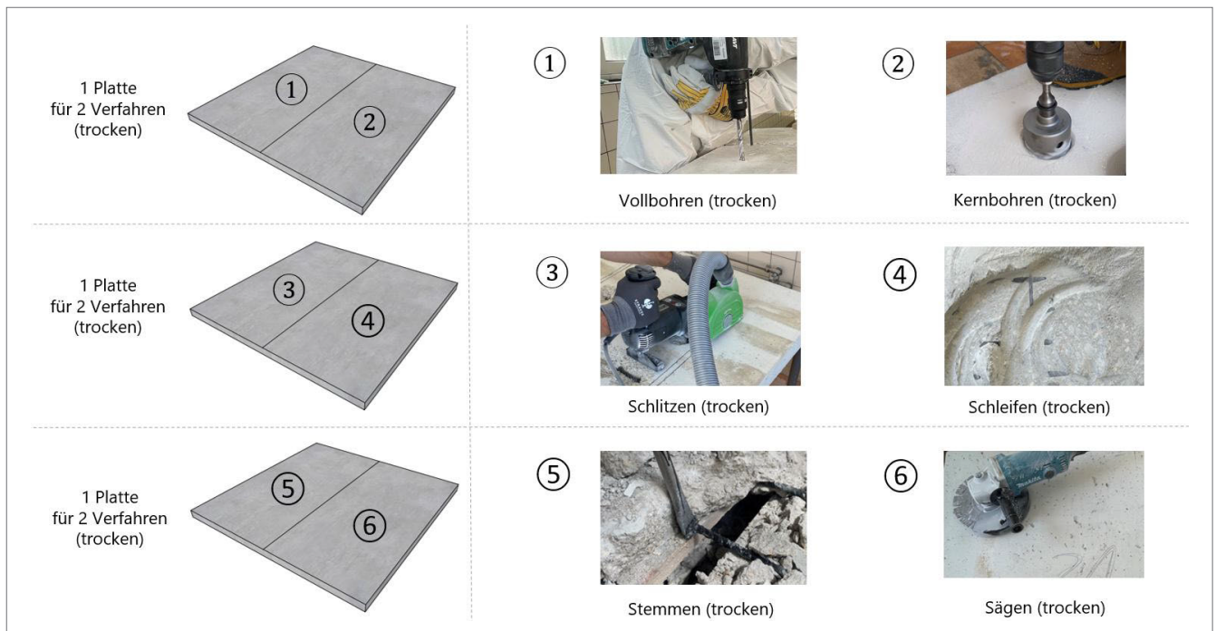
Bild 2. Darstellung der angefertigten Probekörper mit Bearbeitungsverfahren Grafik: IBB (TUD) Fig. 2. Illustration of the test specimens produced, showing the machining processes Source: IBB (TUD)
