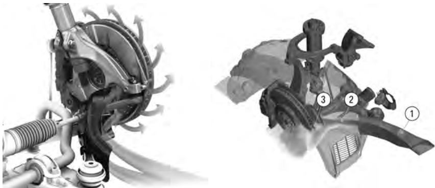
Bild 8: Maßnahmen zur Steigerung des konvektiven Wärmeübergangs einer Bremsanlage: Innenbelüftung der Bremsscheibe und achsfestes Luftleitelement (links, [1]), karosserie-fester Kühlluftschacht (rechts)
