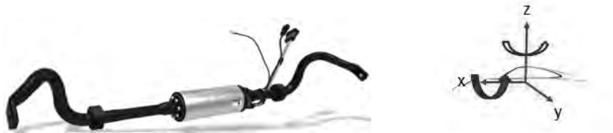
Bild 5: Das elektrische Wankstabilisierungssystem Porsche Dynamic Chassis Control (PDCC)
