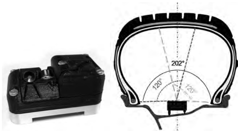
Bild 4: Interner Reifensensor zur Temperatur- und Druckerfassung
