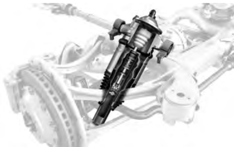
Bild 3: Porsche Active Suspension Management (PASM) mit geregeltm Dämpfer
