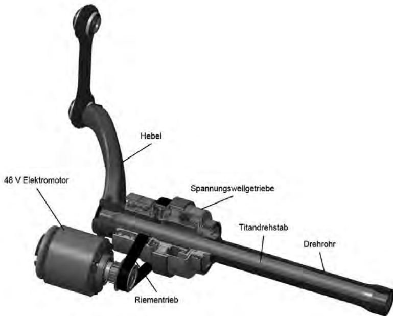
Bild 6: Schnittbild durch die Torsionseinheit eines Aktivfahrwerkstellers.
