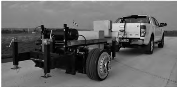
Bild 2: Reifenmessanhänger mit Zugfahrzeug auf dem Testgelände
