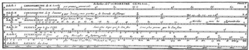
Abbildung 4.3: Joseph Sauveurs Echometre genannter Vergleichsmaßstab. Echelle I zeigt Louliés Pendellängen in pouces universels an, Echelle II die Periodendauern der Pendelschwingung in 1/12 Sekunden. Die Zahlen unter dem Maßstab entsprechen den Periodendauern in 1/60 Sekunden (tierces de temps).
