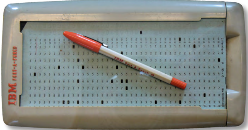
Abbildung 1.6: Eine IBM Port-A-Punch-Lochkarte im 40-Spalten-Format.
