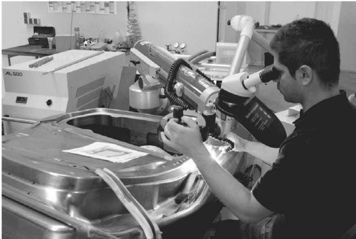
Bild 2: Reparatur eines Presswerkzeugs mit einer handgeführten 500-Watt-Laserschweißanlage
