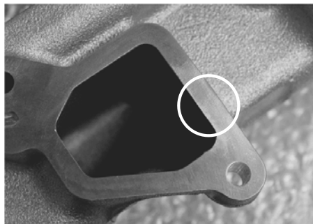
Bild 1: Typisches Bild einer Fehlstelle am fertig bearbeiteten Aluminium-Gussteil inkl. mit Laserschweißtechnologie reparierter Fehlstelle am gleichen Bauteil
