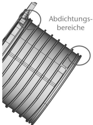
Bild 2: Abdichtungsgebiete mit umlaufenden O-Ringen im Innengehäuse mit erhöhten Anforderungen an die Gussteilporosität
