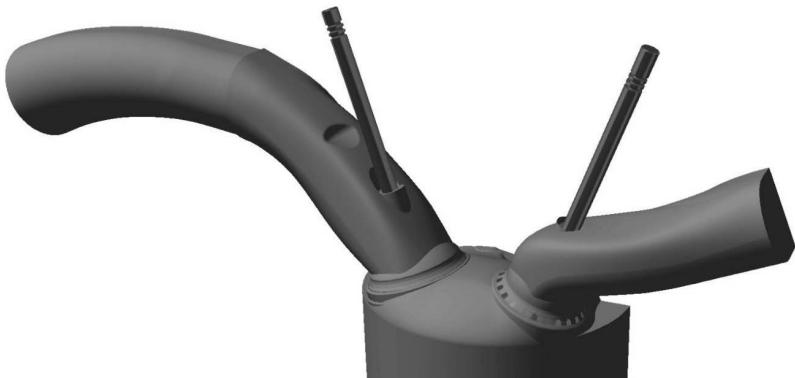
Bild 1: CAD-Modell des 2,5-Liter-Vierzylinders zur Strömungsberechnung
