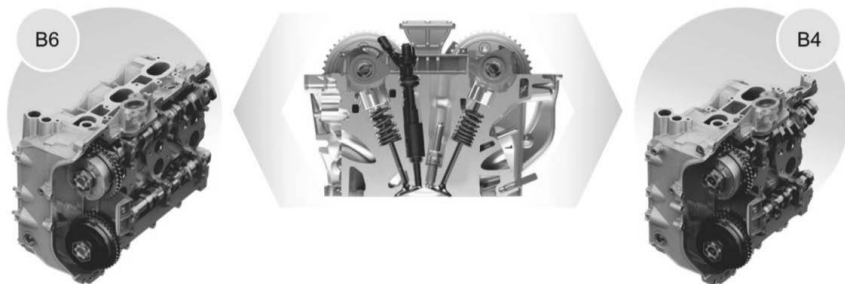
Bild 18: 9A2 Zylinderkopf B6 und B4 mit zentraler Injektorlage
