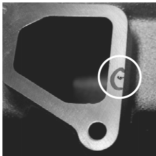
Bild 1: Typisches Bild einer Fehlstelle am fertig bearbeiteten Aluminium-Gussteil inkl. mit Laserschweißtechnologie reparierter Fehlstelle am gleichen Bauteil
