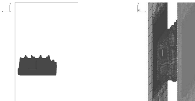
(a) Seitenansicht vom Zylinderkopfnetz und Rahmen des Wasserkastens (b) Zylinderkopf mit Periodizitätsflächen
