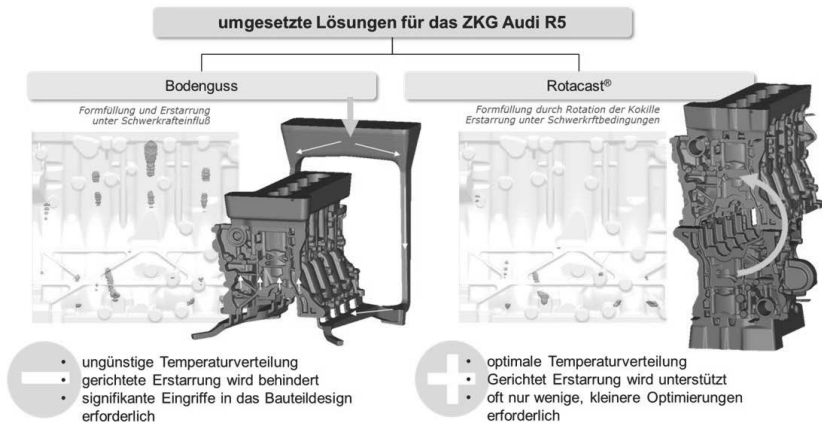
Bild 3: Realisiertes Kokillengussverfahren für das Aluminium-Kurbelgehäuse
