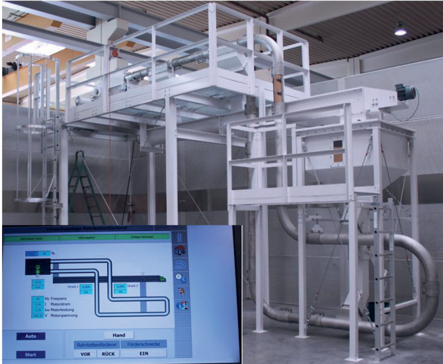
Abbildung 9-2: Versuchsanlage mit optimierten Stauscheiben und Blick auf das Bedienerdisplay
