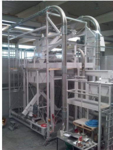
Abbildung 6-15: Versuchsanlage in S - Bogenform mit den beiden Antriebsvarianten direkt hinter dem Fallrohr und direkt vor dem Steigrohr als Planung und aufgebaut in der Dauerbetriebserprobung
