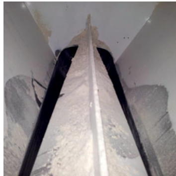
Abbildung 6-4: Rohröffnung als Nierenform zur Zentrierung und Abstützung der Schubelemente, Entwurf und erste Ausführung
