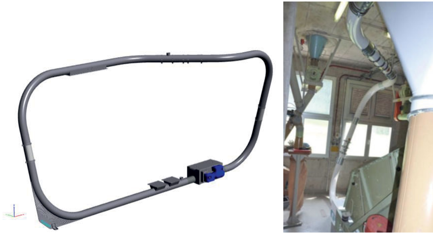
Abbildung 6-13: Planung der 3-D Linienführung im CAD und Darstellung der aufgebauten Förderanlage
