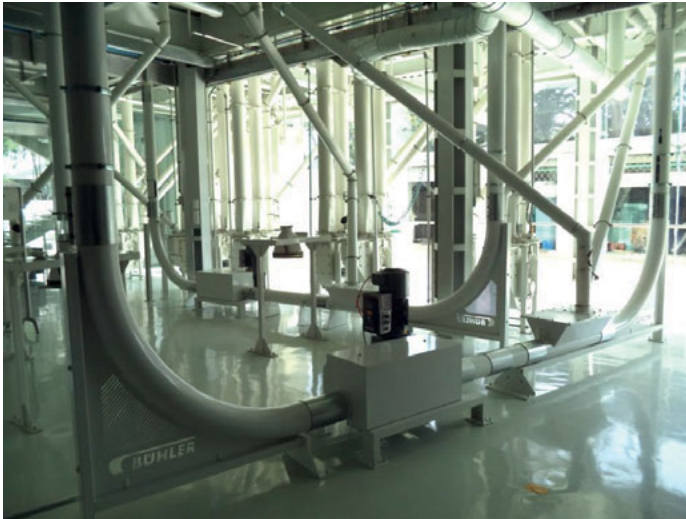
Abbildung 6-12: 6 Inch Versuchsanlagen mit basic Antrieb für Reisanwendungen (Bangalore Indien)
