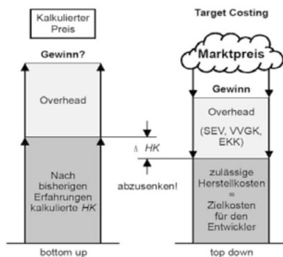
Abbildung 1-15: Festlegung der zulässigen Herstellkosten nach dem Target Costing Prinzip [Erl-2000]
