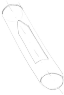
Abbildung 6-3: Rohröffnung mit Zentrierwirkung zur Vermeidung von Produktbruch, Entwurf und erste Ausführung
