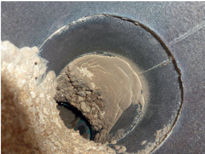
Abbildung 5-42: Ablagerung im Zulaufrohr eines Elevators in einer Reismühle
