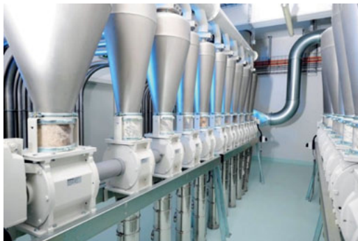
Abbildung 1-12: Druckpneumatikförderstrecken mit Zellradschleusen zum Einschleusen des Fördergutes [Bühler AG]
