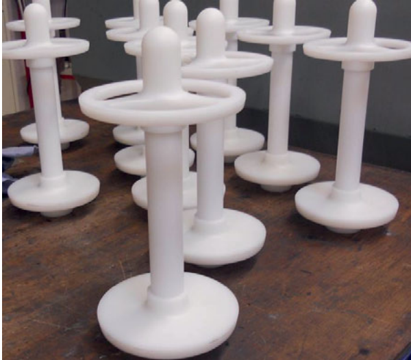
Abbildung 3-4: Schubelemente für das Versuchsmodell aus mehrteiligen Drehteile
