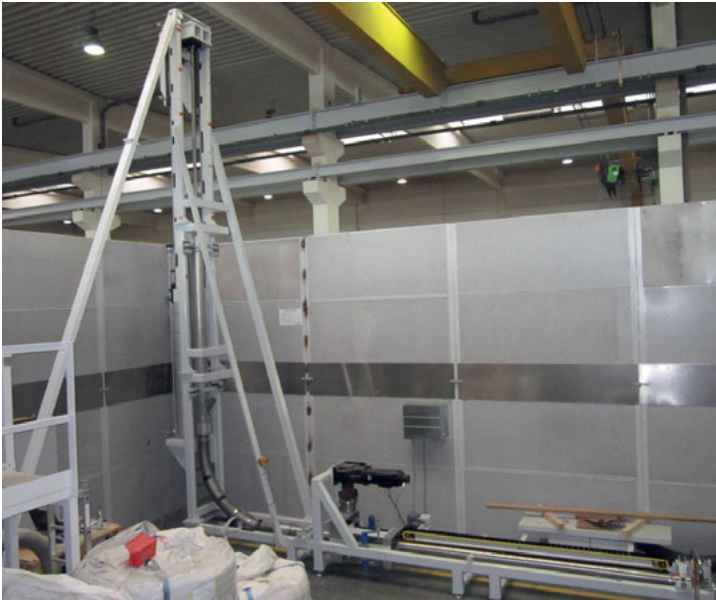
Abbildung 6-7: Montierter Versuchsstand bei der Inbetriebnahme zur Reibungsuntersuchung im ersten Rohrbogen
