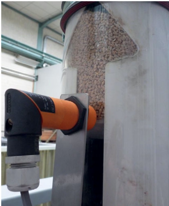
Abbildung 5-64: Messaufbau zur Fördervolumenmessung
