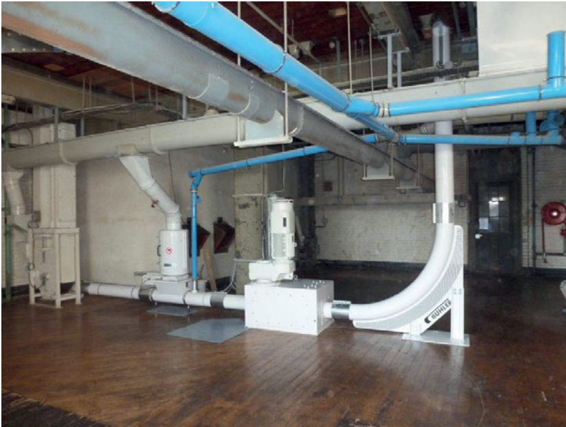
Abbildung 6-16: 8 Inch Versuchsanlage in einer Weizenmühle in Frankreich
