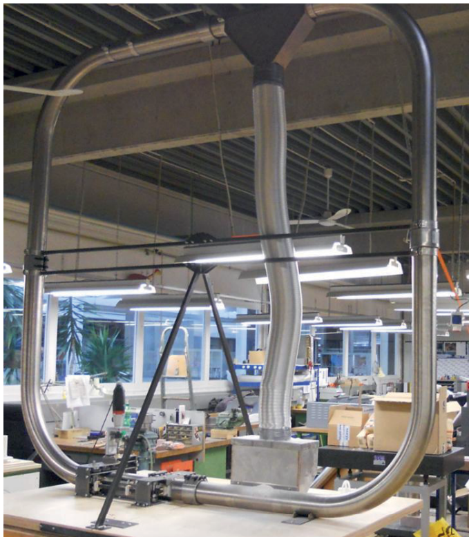
Abbildung 3-5: Versuchsmo­dell im Teilaufbau als O-Anordnung mit Produkteinlass und Produktauslass sowie Antriebsstation
