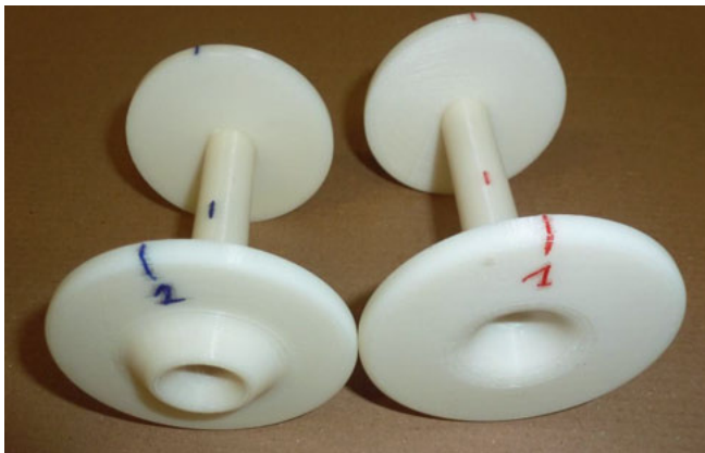
Abbildung 4-18: Versuchsschubelemente mit unterschiedlichem Koppelpunkt bzw. Drehpunkt der Kugel in der Kalotte; Stützscheibe 2: Drehpunkt hinter der Mitnehmerscheibe; Stützscheibe 1: Drehpunkt innerhalb der Mitnehmerscheibe
