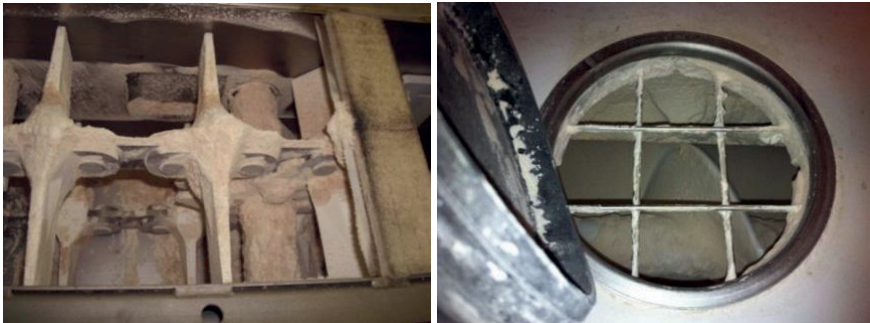
Abbildung 1-14: Schüttgutablagerungen in Trogkettenförderern an den Mitnehmern und im Einlaufbereich einer Trogschnecke
