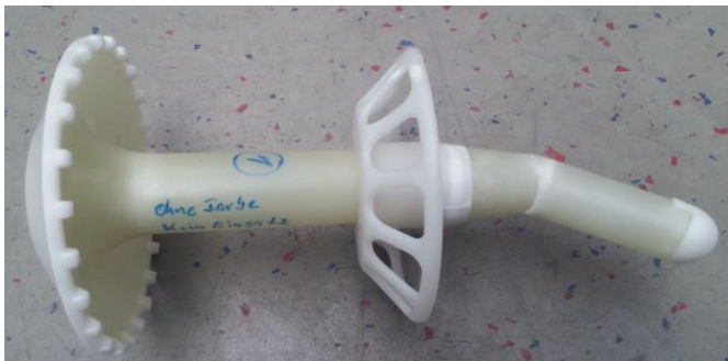
Abbildung 5-28: Versagtes Schubelement nach statischer Druckbelastung
