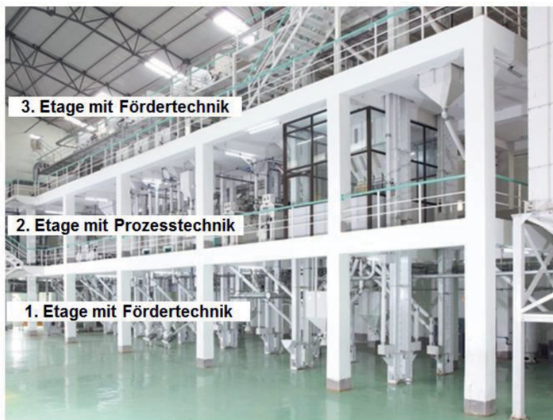
Abbildung 7-5: Aufbau einer klassischen Reismühle über drei Stockwerke mit den wesentlichen Umfängen
