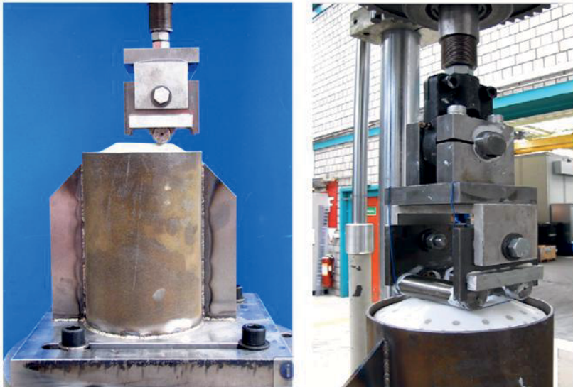
Abbildung 5-31: Versuchsaufbau zur dynamischen Belastung mit hydraulischem Pulsator: links: einseitige (unsymmetrische) Krafteinleitung mit 3,6 kN wie in der basic -Variante; rechts: doppelseitige (symmetrische) Krafteinleitung mit 7kN wie in der standard - Variante
