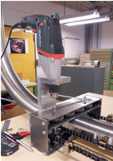
Abbildung 3-7: Schubelementefördererantrieb mit elektrischer Handbohrmaschine
