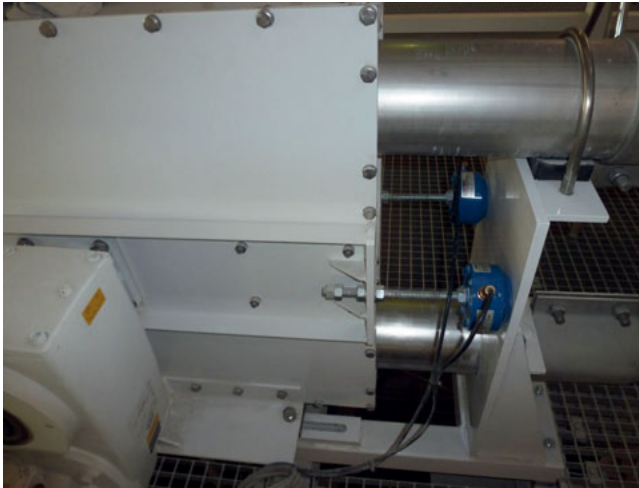
Abbildung 9-5: Messaufnehmer zur Messung der Lagerkräfte
