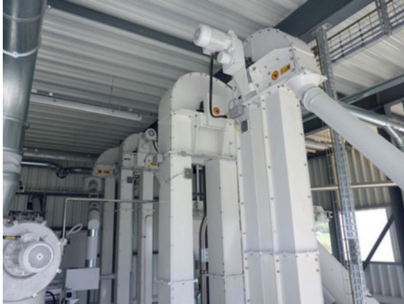
Abbildung 1-10: Elevatoren mit Antriebseinheit im Elevatorkopf [Bühler AG]
