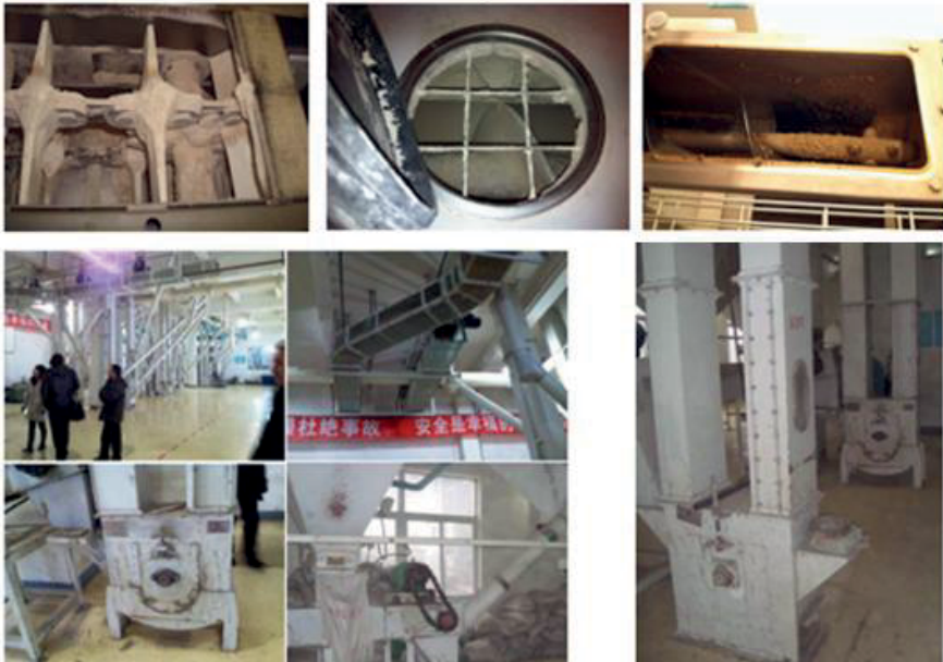
Abbildung 5-41: Problematische Hygieneverhältnisse bei Stetigfördersystemen in der Grundnahrungsverarbeitung
