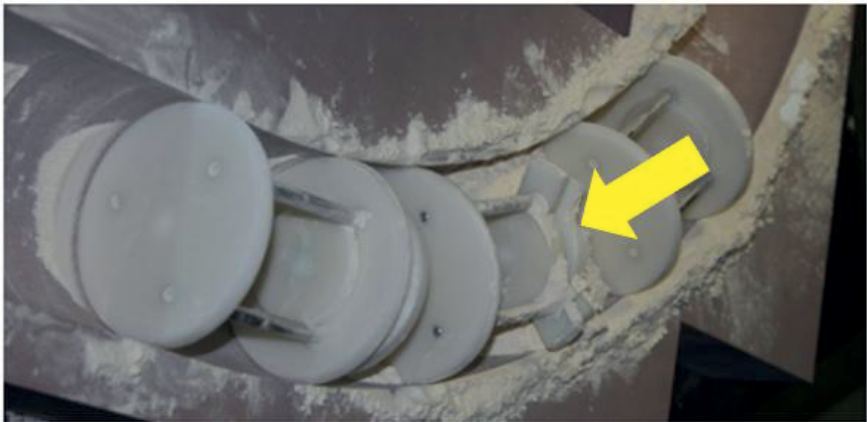
Abbildung 5-10: Koppelstelle der Schubelemente mit reduzierter Stützgeometrie
