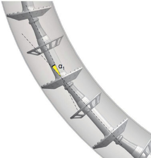
Abbildung 5-26: Winkelstellung \alpha_1=15^\circ im Rohrbogen
