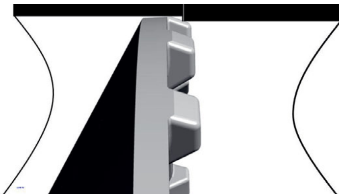
Abbildung 5-9: Zentrierhilfen am Schubelement unterstützen die Zentrierfunktion bei unzureichender Fase an den Rohrstoßstellen
